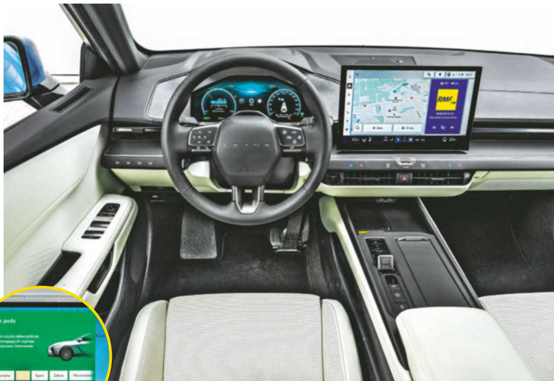
Prostą w rysunku deskę rozdzielczą wykończono bardzo dobrymi materiałami, szczególnie w górnej części. Lexus zachował fizyczne elementy obsługi wybranych funkcji, choć np. tryby jazdy wybiera się wyłącznie poprzez centralny ekran.
