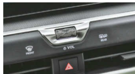
Fizyczne pokrętko głośności. Przyciski obok są niewidoczne, gdy auto jest wyłączone.
