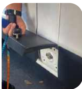
Ten kamperwan kamufluje swoje faktyczne przeznaczenie – zbiornik na LPG ma zawór tankowania ukryty pod elementem fabrycznym
