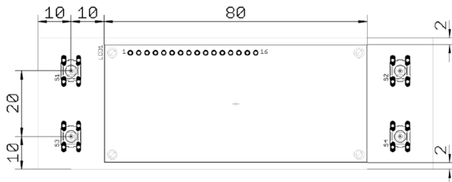
Rysunek 5. Lokalizacja wyświetlacza oraz przycisków na płycie przedniej
