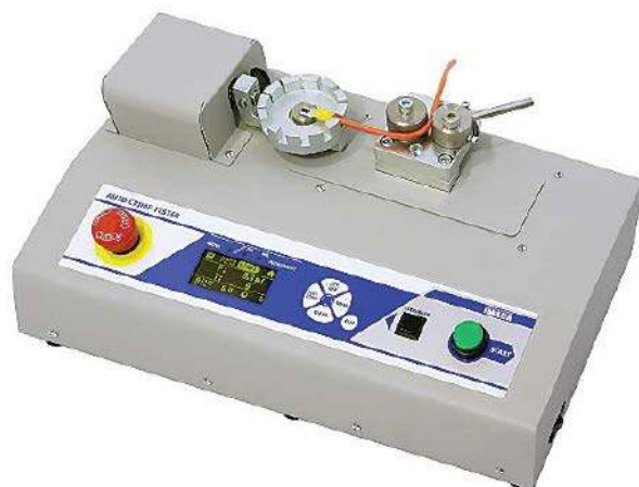
Fotografia 26. Tester siły zerwania do badania jakości połączeń zaciskanych ( http://t.ly/DQRQc )
