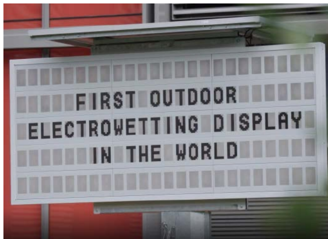
Fotografia 6. Wyświetlacz w technologii elektrozwilżania (EWD) – http://t.ly/uCUYm
