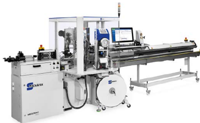
Fotografia 29. Przemysłowy automat przeznaczony do zaciskania konektorów ( http://t.ly/dC7kf )
