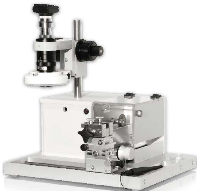
Fotografia 25. Półautomatyczny system do cięcia i mikrofotografii zglądów konektorów zaciskanych – SawInspect System 6 ( http://t.ly/WnCyB )
