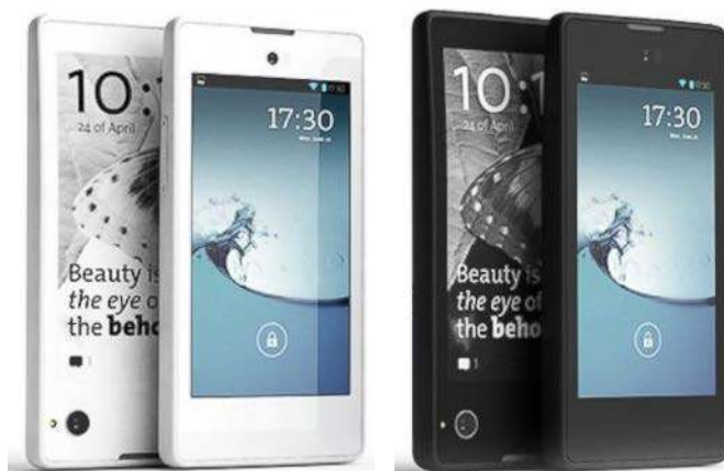
Fotografia 17. Projekt smartfona z wyświetlaczem EPD ( http://t.ly/1qk9w )
