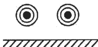
Rysunek 3. Przewody zamontowane na wolnym powietrzu ( http://t.ly/im_yz )
