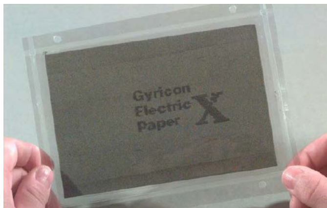
Fotografia 2. Efekt uzyskany z użyciem Gyriconu ( http://t.ly/QbdAt )
