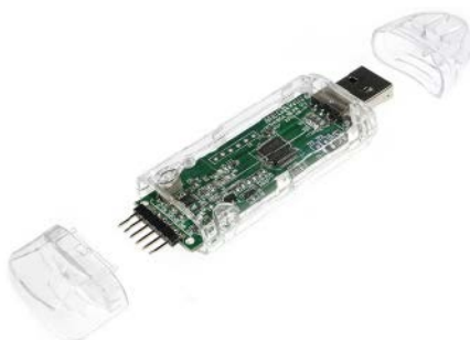
Fotografia 1. Programator MLink marki Megawin ( http://t.ly/z8_9 )
