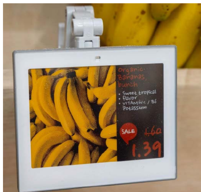
Fotografia 13. Przykład 4-kolorowego wyświetlacza EPD ( http://t.ly/m9Yrp )
