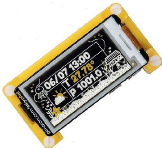
Fotografia 12. Przykład trójkolorowego wyświetlacza EPD z pigmentem żółtym ( http://t.ly/6PgC2 )
