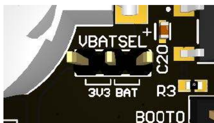
Rysunek 5. Złącze goldpin umożliwiające wybór napięcia linii VBAT
