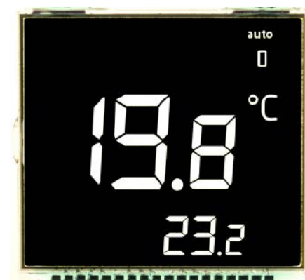
Fotografia 3. Przykładowy wyświetlacz segmentowy opracowany na indywidualne zamówienie
