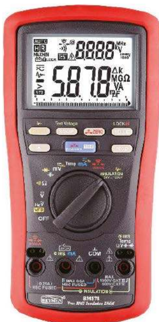
Fotografia 1. Miernik przenośny Brymen BM878 z funkcją pomiaru rezystancji izolacji przy napięciu testowym przestrajnym w zakresie 50...1000 V ( http://t.ly/e_IHJ )
