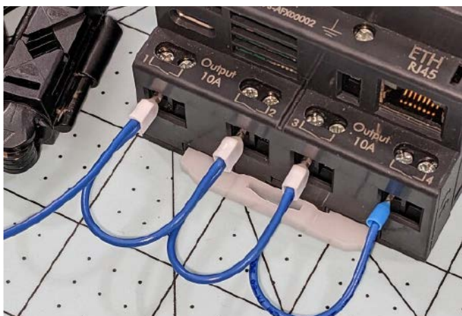
Fotografia 19. Zastosowanie końcówek podwójnych do wykonania połączeń w topologii daisy-chain ( http://t.ly/SfDpr )
