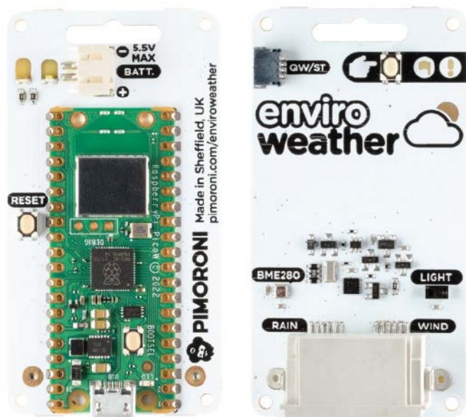
Fotografia 3. Płytkę Enviro Weather, a) widok od dołu, b) widok z góry [9]
