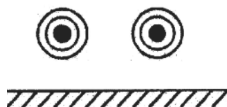
Rysunek 3. Przewody zamontowane na wolnym powietrzu ( http://t.ly/im_yz )
