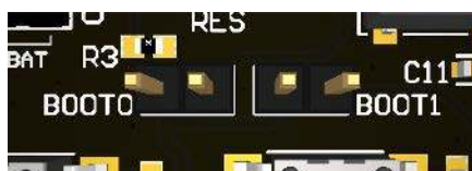
Rysunek 7. Złącza goldpin przeznaczone do wyboru trybu bootowania
