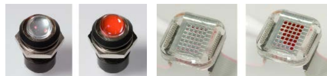
Fotografia 7. Komponenty korzystające z technologii bistabilnego EWD opracowane przez firmę Advanced Display Technologies (ADT) – http://t.ly/nU1Dm
