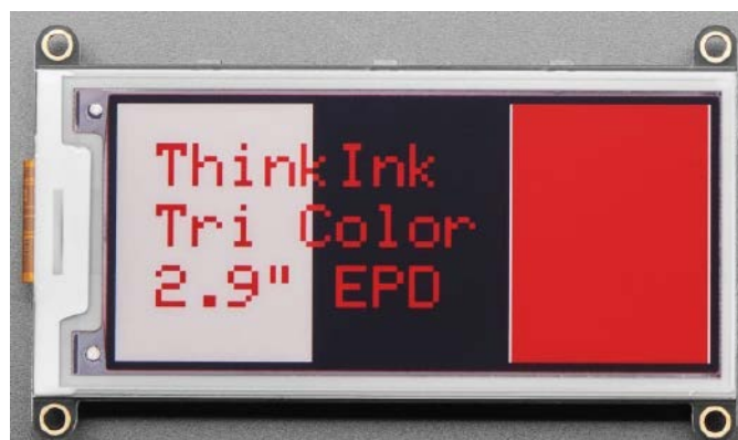
Fotografia 11. Przykład trójkolorowego wyświetlacza EPD z pigmentem czerwonym ( http://t.ly/nSok3 )
