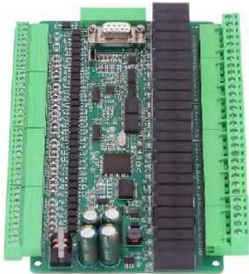
Fotografia 1. Przykładowa płytka drukowana sterownika PLC z widocznym zestawem przekaźników wyjściowych (po prawej). Źródło: http://t.ly/6PO3k
