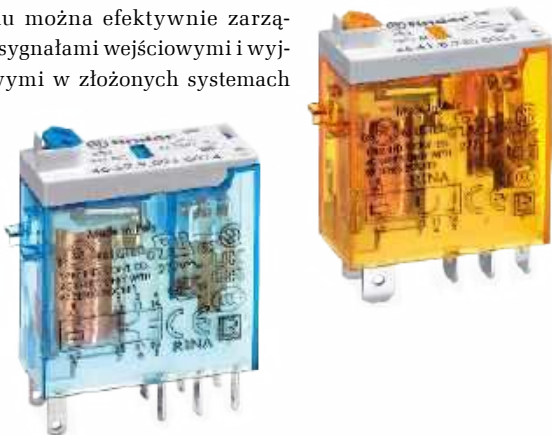
Fotografia 2. Przekaźnik serii 46 z mechanicznym wskaźnikiem zadziałania oraz przyciskiem testującym z funkcją blokowania
