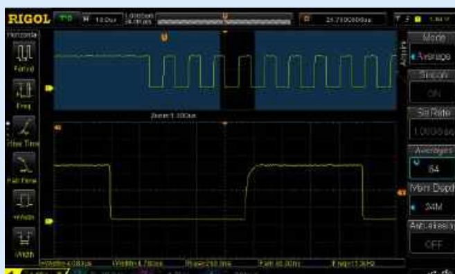
Rysunek 3. Oscylogram prezentujący przebiegi uzyskane na linii SCL
