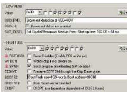
Rysunek 4. Szczegóły ustawienia bitów zabezpieczających
