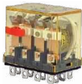
Fotografia 4. Rozbudowany przekaźnik dużej mocy z widocznymi czterema zestawami styków przełącznych, czyli 4PDT ( http://t.ly/5vUPN )
