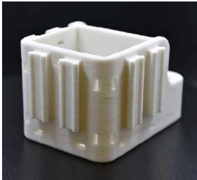
Fotografia 5. Przykładowy wydruk 3D z materiału PA12 (nylon)
