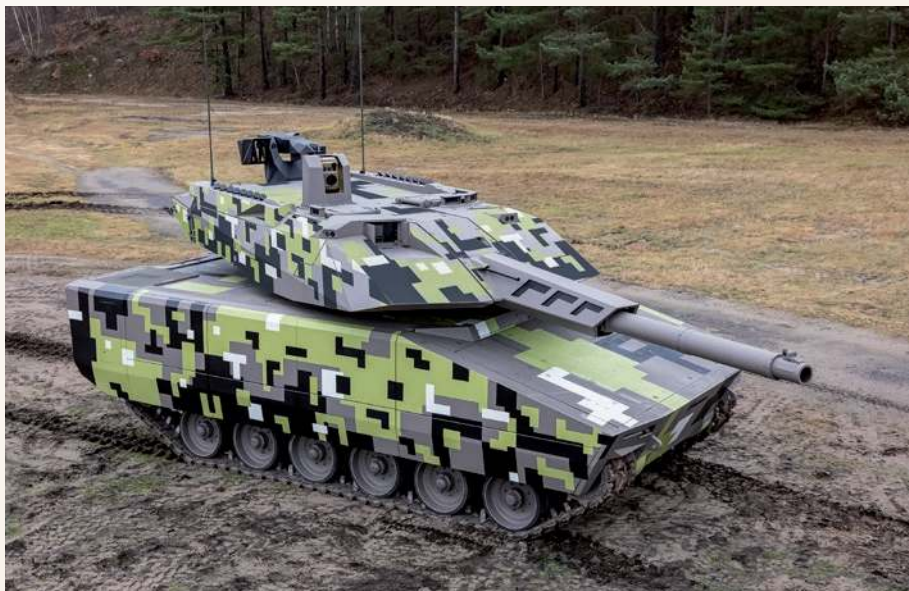
◀ Lynx to rozwijana rodzina wozów bojowych. Kilka lat temu Rheinmetall zaprezentował wóz wsparcia ogniowego Lynx 120 uzbrojony w gładkolufową armatę kal. 120 mm.
