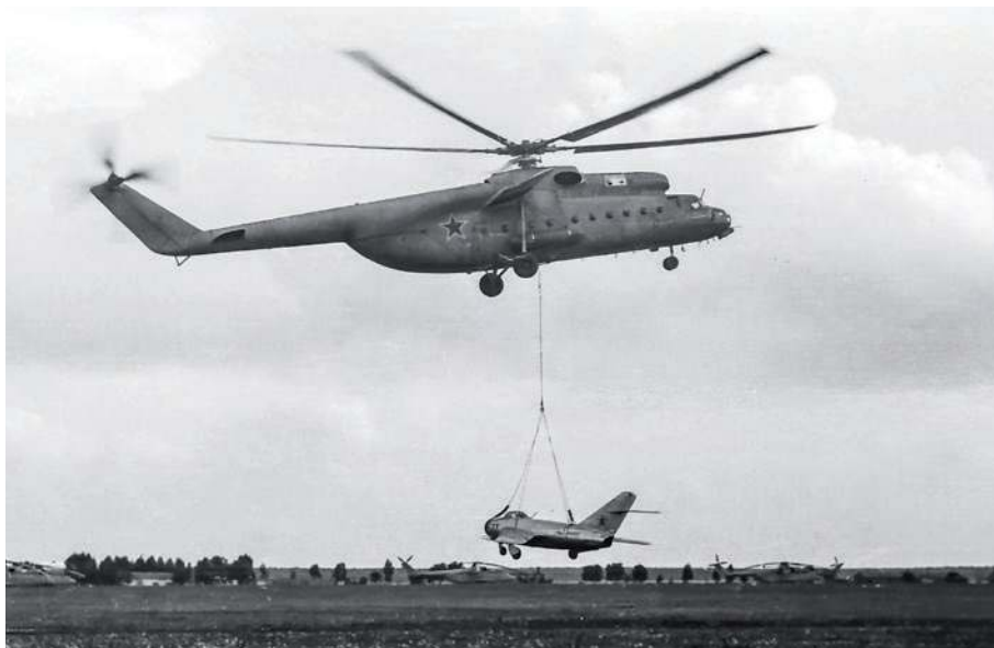
► Ciężkie śmigłowce transportowe Mi-6 eksploatowano w samodzielnych pułkach śmigłowców razem ze średnimi Mi-4, a później także Mi-8. Śmigłowiec Mi-6 numer burtowy „100” z 51. SGwPŚ przewozi na podwieszeniu zewnętrznym samolot myśliwski MiG-17 (Brody, 1971 r.).
