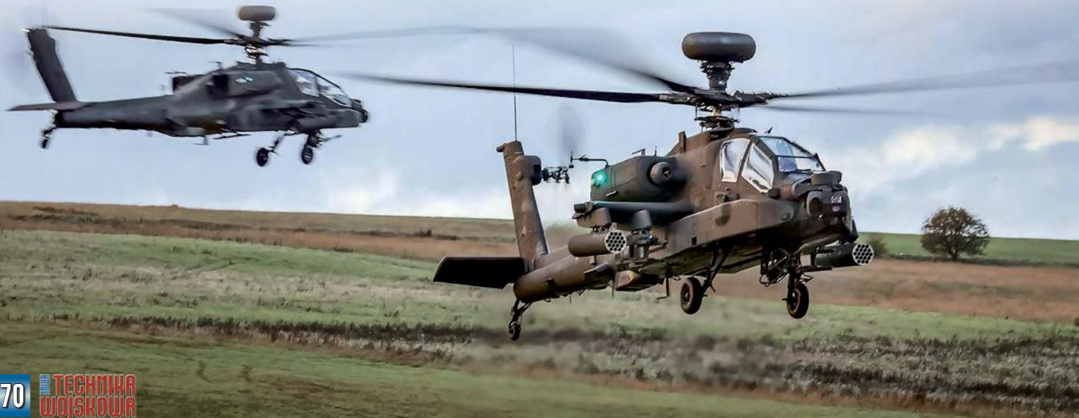
▼ W latach 2020–2025 Boeing zmodernizował 50 śmigłowców szturmowych Apache AH1 (AH-64D Block I) do wersji AH-64E Apache Guardian .
