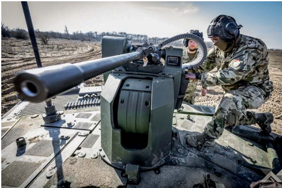
▲ Bezzałogowe stanowisko ogniowe MSSA z wkm M2HB kal. 12,7 mm zamontowano na stropie wieży.
