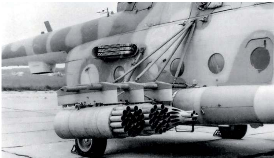
◀ Mi-8MTW z nietypowym mieszanym wariantem uzbrojenia: dwie wyrzutnie B8W-20 dla npr kal. 80 mm oraz jedna UB-32-57 dla npr kal. 57 mm. Maszyna z 442. Samodzielnego Pułku Śmigłowców (bojowy i dowodzenia) z lotniska Żowtnewe (obwód wołyński), koniec lat 80.
