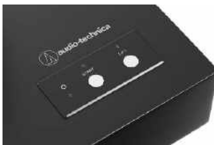
AT-LP8X to konstrukcja półautomatyczna z elektroniczną windą, sterowaną przyciskiem.
