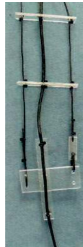
Rozpórki z płytek akrylowych
