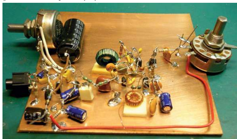
Pierwsza wersja odbiornika DC2020/40 m (potencjometr strojenia jest po prawej stronie, głośność po lewej, a wejście RF jest przez mały emaliowany drut wychodzący z cewki do dołu)
