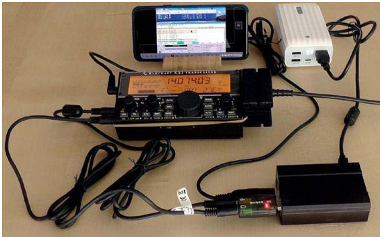
Kompletne wyposażenie do pracy terenowej. Oprócz radiostacji KX2 składają się na nie modem FT8-Box, telefon androidowy i akumulator 5 V. FT8 jest emisją o stałej obwodni dlatego też radiostacja ma dodatkowy radiator zapobiegający jej przegrzaniu
