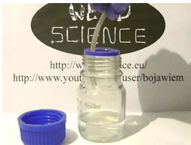
Fot. 4 – Wprowadzanie gazowego chloru ponad powierzchnię roztworu
