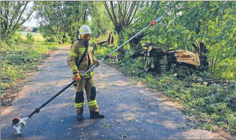
✚ - Pierwszy raz korzystaliśmy z zakupionej w zeszłym roku piły stihl na wysięgniku. Pozwala ona na przycinanie gałęzi nawet do 5 metrów od ziemi. Podczas tego zdarzenia bardzo pomogła podczas działań - zaznaczają strażacy z Goćławia
