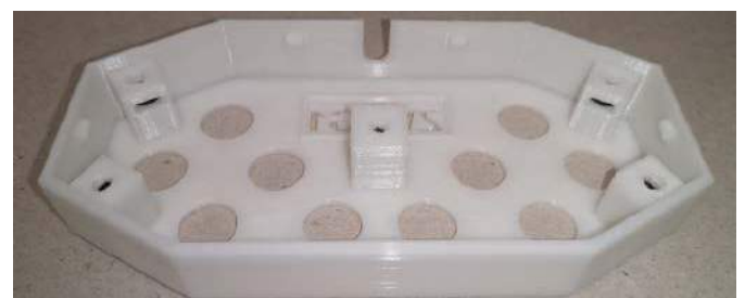
Fotografia 4. Pogłębienie otworów montażowych i umiejscowienie nakrętek M3
