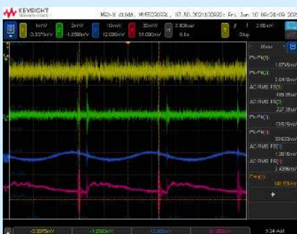
Rysunek 11. Szumy zasilania, pomiar w trybie High Resolution
