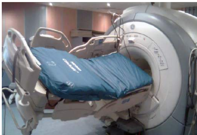
Fotografia 26. Efektowny przykład wypadku, polegającego na wjechaniu w rejon gantry z łóżkiem nieprzystosowanym do pracy przy MRI ( https://t.ly/u8Hr )
