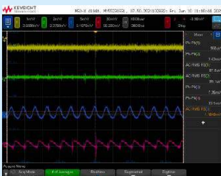
Rysunek 12. Szumy zasilania, pomiar w trybie Averaging (8 uśrednień)
