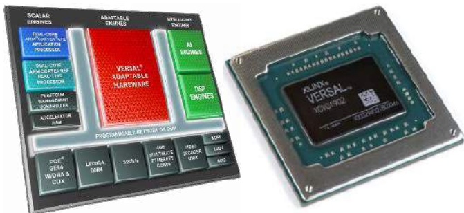
Rysunek 3. Architektura Versal łączy różne typy silników z bogactwem połączeń i możliwości komunikacji, dzięki czemu doskonale nadaje się do adaptacyjnego wnioskowania i zaawansowanego przetwarzania sygnałów
