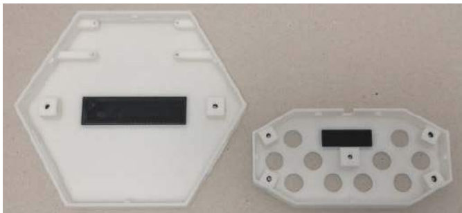
Fotografia 5. Wklejenie czarnych zaślepek w górnej części bazy oraz kontrolera
