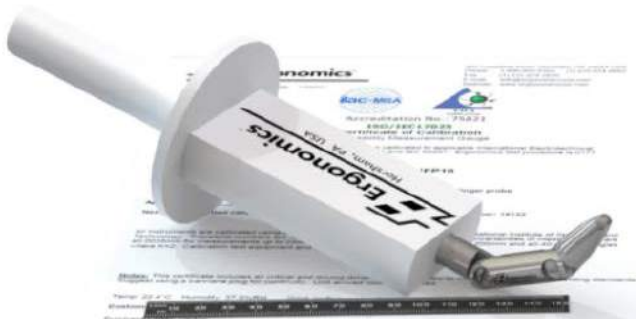
Fotografia 21. Znormalizowany palec probierczy zgodny z normą 60601-1 ( https://t.ly/9FO4 )
