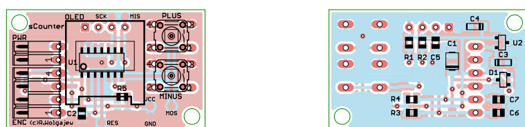
Rysunek 3. Schemat montażowy licznika sCounter
