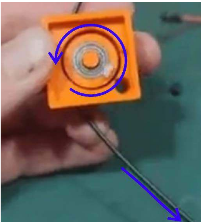
Rysunek 2. Zasada działania mechanicznego sensora do pomiaru długości zużywanego filamentu
