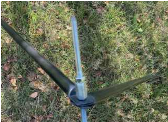
Na końcówki nóg statywu nakładamy poprzeczki usztywniające i przykręcamy groty
