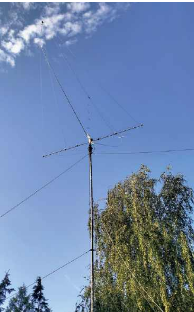
Rys. 1. Połączenie elementów w antenie Multi-Vee
