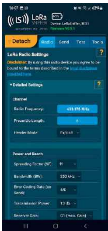
Fot. 3. Przykład ustawienia parametrów transmisji LoRa dla sieci Meshcom
