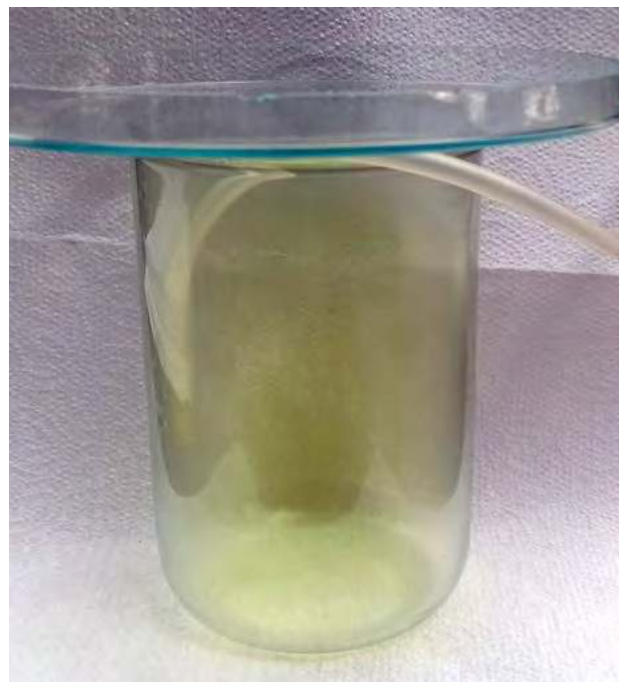
Fot. 4 – Pojemnik wypełniony chlorem; wyraźnie widoczna zielonożółta barwa gazu
