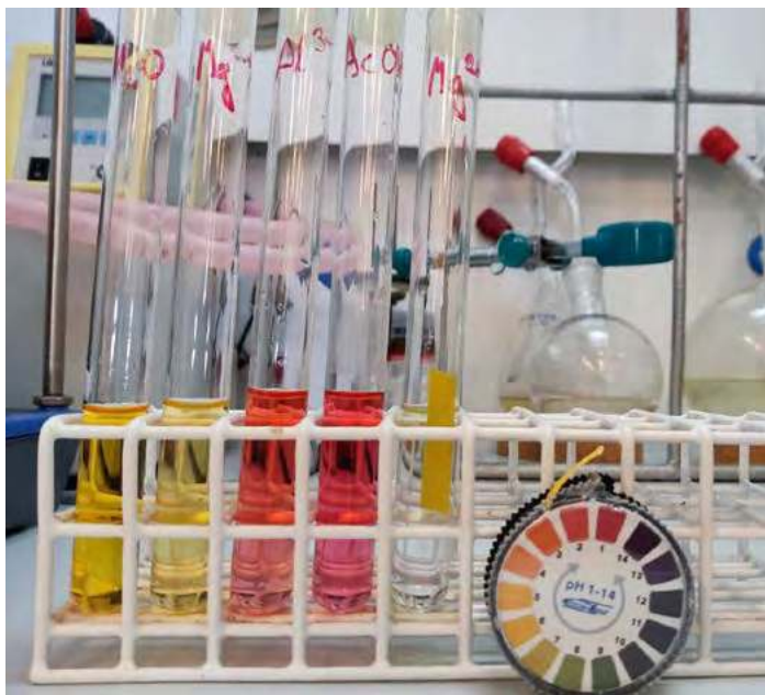
Fot. 1. Barwy wskaźników w roztworach różnych soli: oranżu metylowego wobec wody (pierwsza z lewej), a dalej wobec roztworów o stężeniu 0,2 \text{ mol/dm}^3 : \text{MgSO}_4 , \text{KAl(SO}_4)_2 , \text{CH}_3\text{COOH} . Ostatnia z prawej: uniwersalny papierek wskaźnikowy w roztworze \text{MgSO}_4 o stężeniu 0,2 \text{ mol/dm}^3 . Przygotowanie roztworów do tego doświadczenia opisane jest na końcu artykułu.
