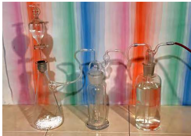
Fot. 10 – Układ doświadczalny zestawiony według schematu z rys. 1 – przed wlianiem wody amoniakalnej do środkowego naczynia
