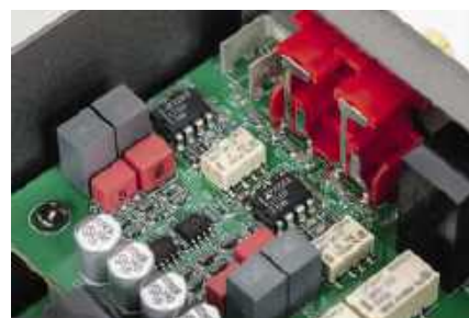
Układ korekcji gramofonowej wykonano na bazie niskoszumowych wzmacniaczy operacyjnych.
