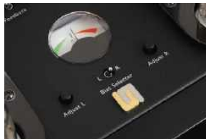
Pomiędzy lampami zainstalowano wskaźnik oraz regulatory biasu lamp; producent zaleca kontrolę ustawień po każdym uruchomieniu wzmacniacza.
