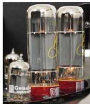
Końcówki mocy to układ push-pull oparty na oryginalnych tetrodach strumieniowych KT77.
