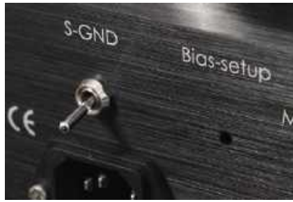
Niewielki przycisk wywołuje automatyczną procedurę regulacji biasu lamp.
