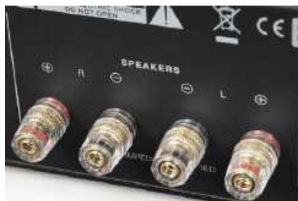
Pojedyncze odczepy transformatorów głośnikowych nominalnie zoptymalizowano dla 6 Ω, ale bez obaw możemy podłączyć kolumny 8- i 4-omowe.
