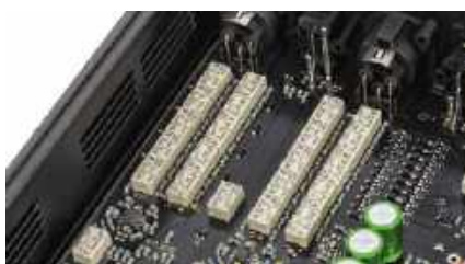
Najciekawszym autorskim rozwiązaniem jest układ regulacji głośności wykonany w technice R2R.
