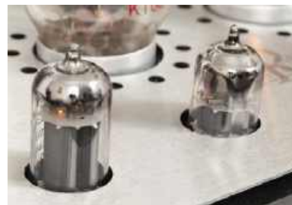
Lampy w sekcji sterującej oraz w przedwzmacniaczu to podwójne triody ECC83 oraz 12BH7.
