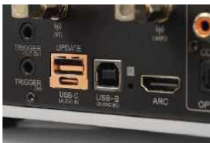
W sekcji cyfrowej znajdują się dwa wejścia USB i HDMI z kanałem zwrotnym ARC.
