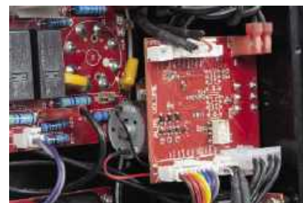
Do lampowca pasuje klasyczna regulacja głośności z potencjometrem Alpsa.
