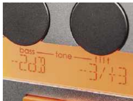
Ciekawostką są nietypowe korekcje charakterystyki (firmowy układ Tilt).
