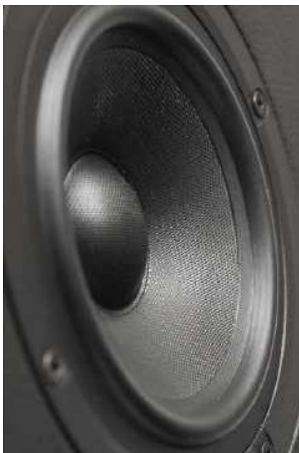
Drobna plecionka z włókna szklanego to sposób na małą masę i dobre tłumienie rezonansów membrany średniotonowej.
