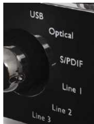
Selektor źródeł ma rekordową liczbę pozycji za sprawą obecności sekcji cyfrowej i jej trzech wejść.
