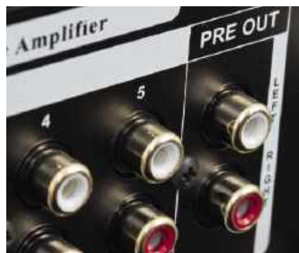
Wejść jest jednak aż pięć, dodano też wyjście z przedwzmacniacza.
