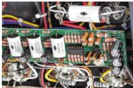
Największa płytka obejmuje firmowy system kontroli i kalibracji biasu lamp.
