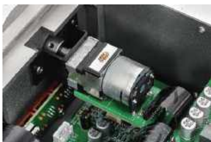
Jednym z nielicznych odwołań do klasyki w 33 jest regulacja głośności prowadzona za pomocą tradycyjnego potencjometru Alpsa.
