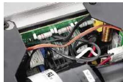
Moduły wzmacniające (tradycyjna klasa AB) przykręcono w pobliżu przedniego panelu, mającego formę i funkcję radiatora.
