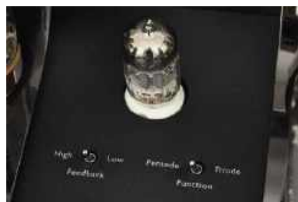
Triode 25 BE może pracować w trybie triodowym lub ultraliniowym, użytkownik decyduje też o głębokości sprzężenia zwrotnego.
