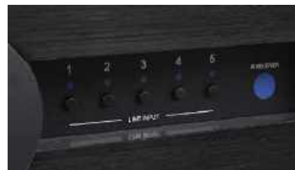
Selektor wejść jest złożony z pięciu przycisków z diodami sygnalizującymi wybór.
