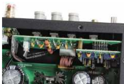
Półprzewodniki zastosowano także w układzie korekcji barwy (można go ominąć funkcją Direct).
