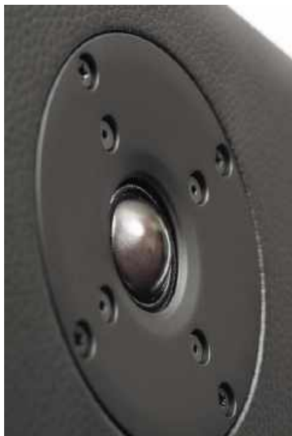
Scan-Speak D2608/913000 – 25-mm tekstylna kopułka o wysokiej efektywności, dzięki silnemu układowi magnetycznemu; aluminiowy front wyprofilowany w płytki falowód.
