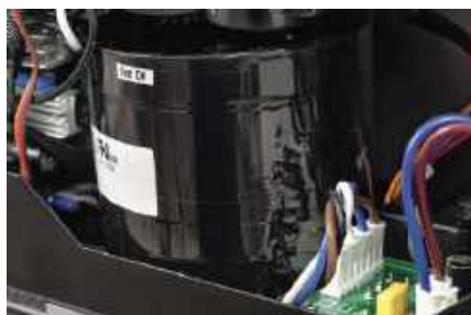
Duży, toroidalny transformator zasilający przymocowano do dolnej ścianki.
