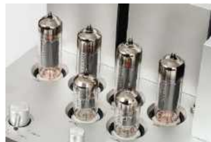
Słynne "piecykowe" pentody EL84 pracują w stopniu wyjściowym, nie mniej znane ECC83 – w przedwzmacniaczu.
