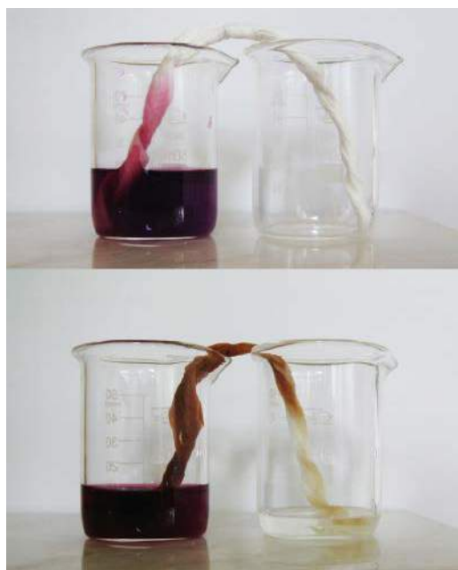
3. Adsorpcja – substancja rozpuszczona w cieczy jest zatrzymywana przez papier (ponownie widoczna barwa będąca efektem reakcji nadmanganianu potasu z substancjami organicznymi papieru)
