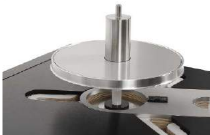
Magnetyczne łożysko wraz z subtalerzem za chwilę osunie się niżej; na zewnętrzny rant należy założyć pasek napędowy.
