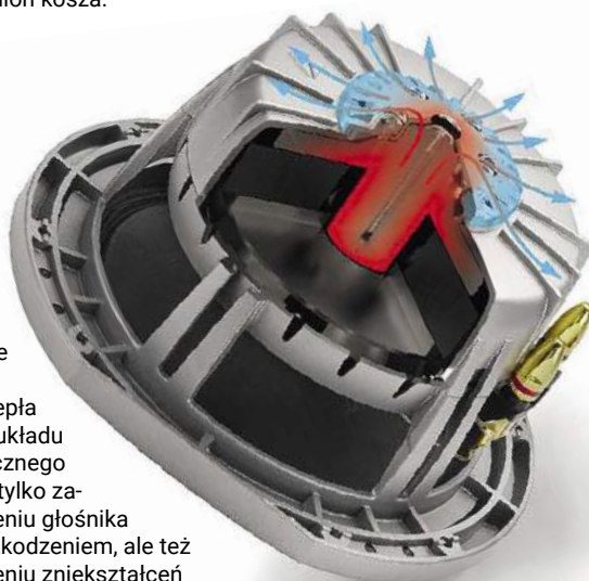
Z tyłu magnesu znajduje się element transmitujący ciepło z rdzenia i górnego nabiegunka układu magnetycznego (elementów ukrytych wewnątrz) do zewnętrznej osłony sięgającej aż do ramion kosza.
