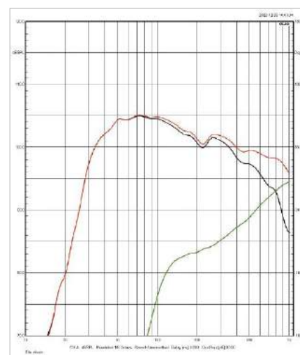
rys. 4. charakterystyki sekcji niskotonowej i średnionowej (poniżej 1 kHz, pomiar w polu bliskim).
