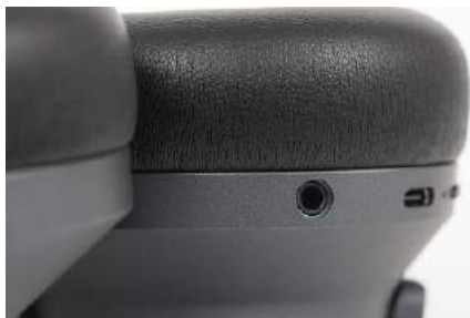
Słuchawki mogą pracować w trybie pasywnym, z niezależnym złączem analogowym (gniazdo mini-jack)
