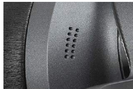
Na każdej muszli znajdują się aż cztery mikrofony, część dla systemu ANC, a część dla układów wspomagających rozmowy telefoniczne
