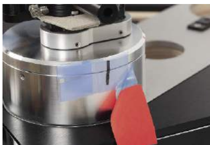
Do zadań użytkownika należy montaż ramienia, zgodnie z oznaczeniami na taśmach.
