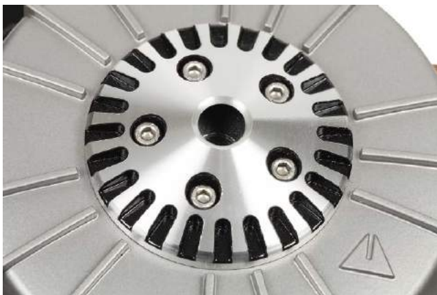
Z tyłu magnesu znajduje się element transmitujący ciepło z rdzenia i górnego nabiegunka układu magnetycznego (elementów ukrytych wewnątrz) do zewnętrznej osłony sięgającej aż do ramion kosza.
