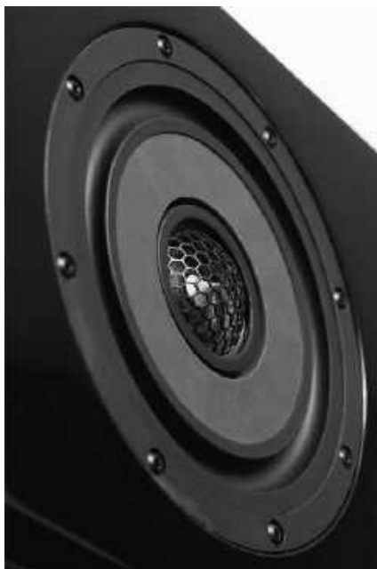
Przetwornik średniotonowy ma płaską membranę, co ułatwiło instalację wysokotonowego, którego układ magnetyczny znajduje się przed układem średniotonowego.
