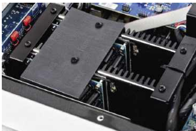
Jedną z najważniejszych zmian w wersji V2 to nowe końcówki mocy Purifi Eigentakt.
