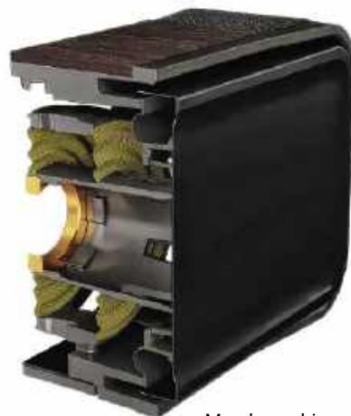
Membrany bierne mają podwójne dolne zawieszenie i dociążenie układu drgającego w formie pierścienia na końcu cylindra.
