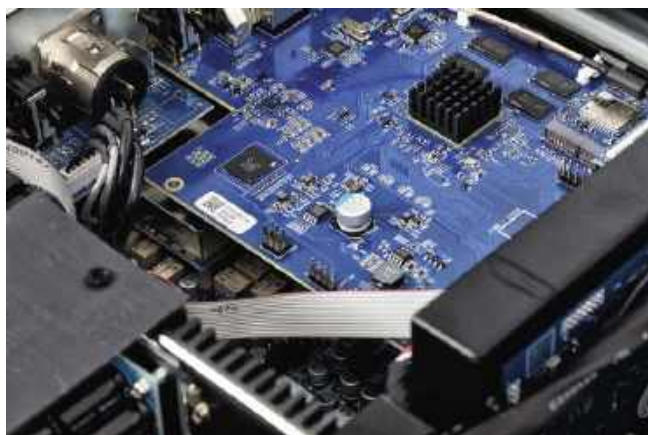
Przedwzmacniacz składa się z układów sieciowych (na górze) i sekcji przetworników razem z torem analogowym (na dole).
