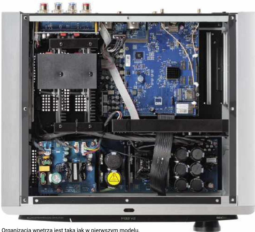
Organizacja wnętrza jest taka jak w pierwszym modelu, ale zmodyfikowano znaczną część układów cyfrowych oraz końcówki mocy.
