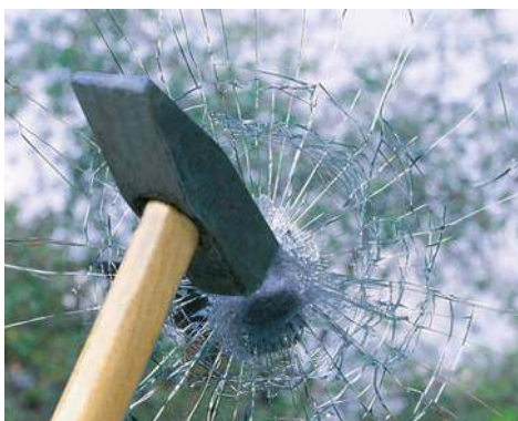
❗ Antywłamaniowa szyba po zbitiu zostaje w ramie. VETREX
