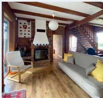
➔ Kominek z płaszczem wodnym ma tzw. ciepłą obudowę (z cegły).
