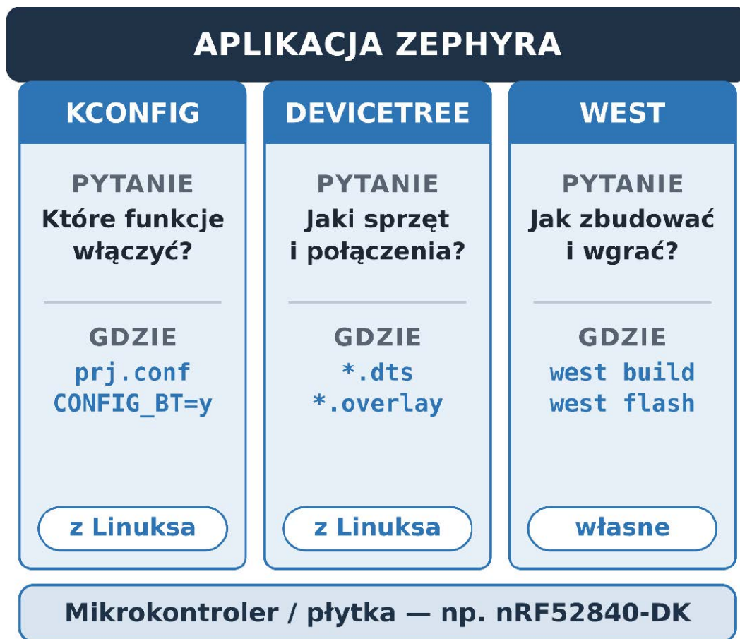
Rysunek 4. Trzy filary, na których stoi każda aplikacja Zephyra. Każdy odpowiada na inne pytanie; dwa z nich – Kconfig i Devicetree – Zephyr przejął wprost z ekosystemu jądra Linuksa
