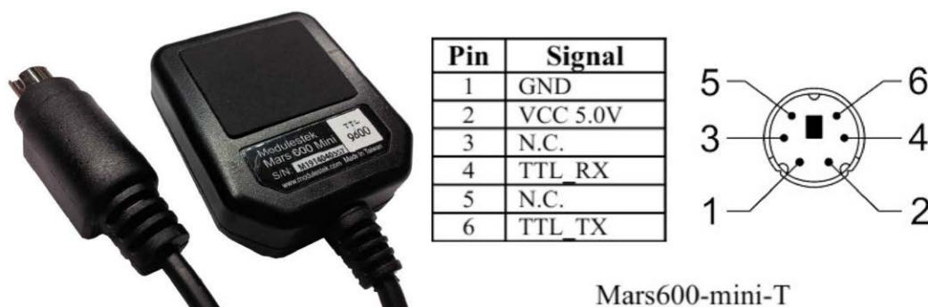
Rysunek 6. Przykładowy odbiornik GPS MARS600 (moduł u-blox 6) wraz z opisem wyprowadzeń złącza
