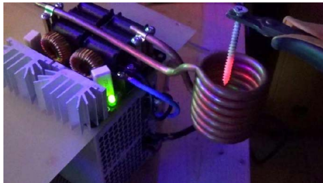
Rysunek 10. Obiekt umieszczony w cewce roboczej rozżarza się w ciągu kilku sekund
