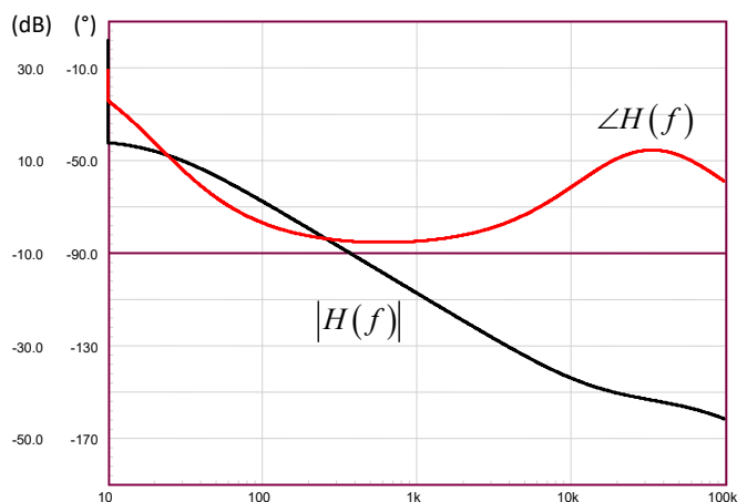
Rysunek 9. Pracując w trybie DCM, przetwornica buck w trybie VM nadal pozostaje układem drugiego rzędu
