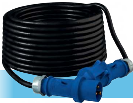
Przedłużacz kempingowy o długości 25 m, 16A/3P IP44 230V H07RN-F 3x1,5. Kod produktu: DV-2698-C-16
