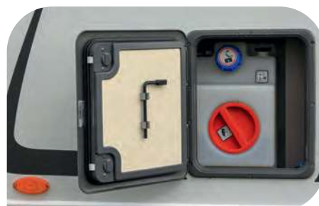
Luk na 2 butle gazowe, obok dostęp do zbiornika wody socjalnej; miejsce dla klucza spustu szarej wody na drzwiczkach to świetny pomysł
