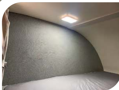
Tapicerowany panel na bocznej ścianie wewnątrz alkowy – rozwiązanie firmy Kampery Suwałowski
