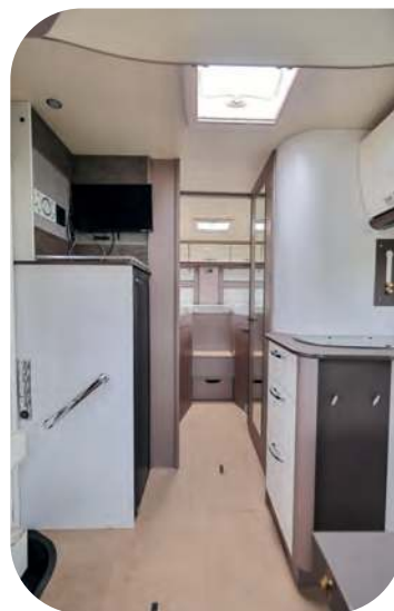
W podłodze korytarza znajdują się 2 potężnych rozmiarów schowki z polistyrenowym dnem; tylny jest na tyle długi, że aby osiągnąć schowane głębiej przedmioty, trzeba posłużyć się pomocnikiem, na przykład kijem od miotły
