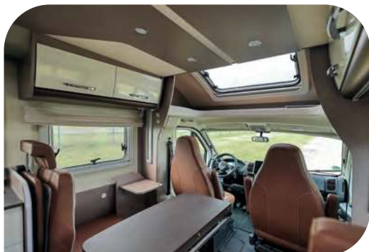
Szoferka wraz z miejscami pasażerskimi przygotowanymi do jazdy; każde z nich posiada składany stolik...
