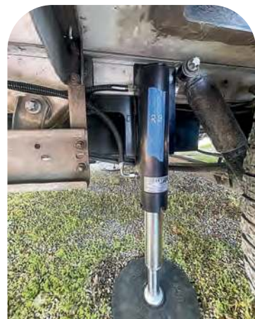
Podnośniki hydrauliczne mają wiele zastosowań w caravanningu. Wypoziomowanie pojazdu podczas postoju to tylko jedno z nich
