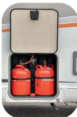
Luk na 2 butle gazowe, obok dostęp do zbiornika wody socjalnej; miejsce dla klucza spustu szarej wody na drzwiczkach to świetny pomysł
