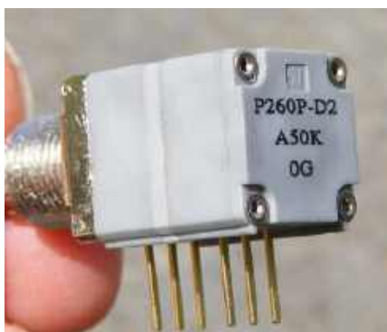
Rysunek 40. Uszczelniony potencjometr BI P260 ze ścieżką z tworzywa przewodzącego oferuje bardzo korzystny stosunek jakości do ceny. Ma niewielkie wymiary, suwak z czterema stykami ślizgowymi, nadaje się do montażu na płytce drukowanej i jest dostępny w firmie Profusion.
