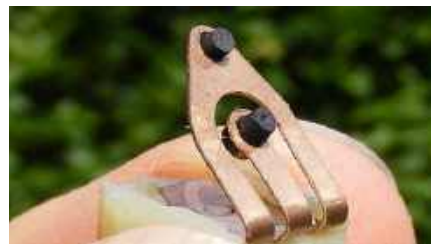
Rysunek 12. Większość potencjometrów ze ścieżką węglową formowaną na gorąco ma węglowe styki suwaka, jak w modelu Plessey MH1. Pozwala to zmniejszyć poziom trzasków podczas obracania w porównaniu z suwakami metalowymi.
