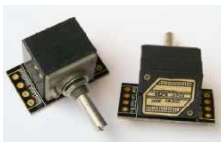
Rysunek 38. Seria Alps Blue Velvet to jedno z najlepszych potencjometrów ze ścieżką węglową dostępnych na rynku. Są cenione przez projektantów wzmacniaczy Hi-Fi. Można je kupić w firmie Mouser oraz w serwisie eBay.
