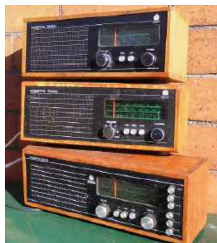
Rysunek 22. Sieciowe odbiorniki radiowe Roberts są bardzo popularne, ale często mają wadliwe regulatory głośności, których działanie jest wyjątkowo nieprzyjemne dla uszu. W górnej części zdjęcia pokazano wcześniejszy model RM20 z zakresem AM, pozbawiony tej wady dzięki zastosowaniu wzmacniacza zbudowanego z elementów dyskretnych. W dwóch modelach FM widocznych poniżej zastosowano układ scalony o zbyt dużym wzmacnieniu.
