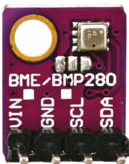
Rysunek 11.2. Moduł z czujnikiem BME280 wyposażony w układy interfejsu I²C umieszczone po drugiej stronie płytki.
