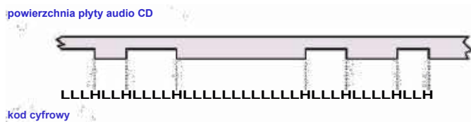
Zależność między szeregowym strumieniem danych a rozmieszczeniem zagłębień i obszarów między nimi na płycie (© 2020 Jos Verstraten)
