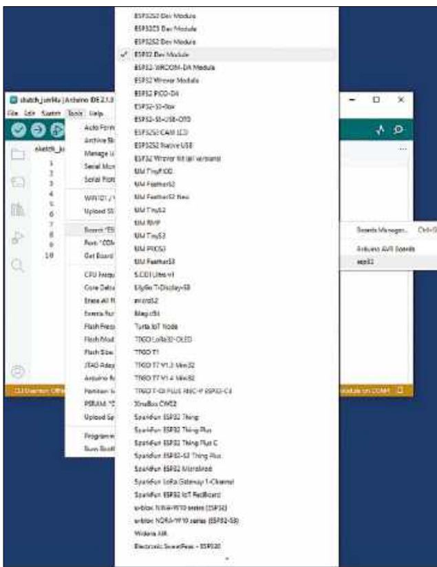
Rysunek 1.15. Wybór typu płytki z listy obsługiwanych urządzeń.
