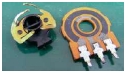
Rysunek 17. W nowszych potencjometrach Omeg P20 środkowy pierścień ślizgowy zastąpiono drukowaną ścieżką z polimeru węglowego, co wyeliminowało opisany wcześniej rodzaj uszkodzenia i znacznie zmniejszyło poziom szumów.
