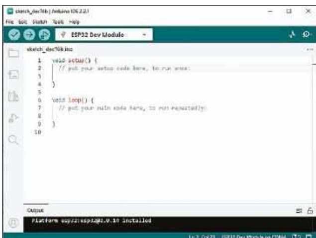
Rysunek 1.16. Środowisko Arduino IDE jest połączone z modułem ESP32 przez port szeregowy COM4 i gotowe do wgrywania programów. Pokazany program stanowi jedynie szkielet.
