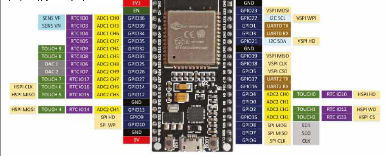
Rysunek 1.6. Rozkład wyprowadzeń typowej 36-pinowej płytki rozwojowej ESP32.
