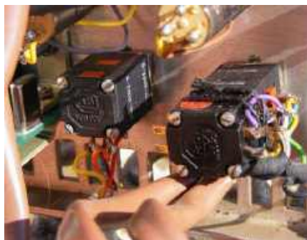
Rysunek 15. Na szczęście dla serwisantów nie-standardowe potencjometry ModPot zastosowane w analizatorze AMS1 są skręcane śrubkami, co ułatwia ich serwisowanie.
