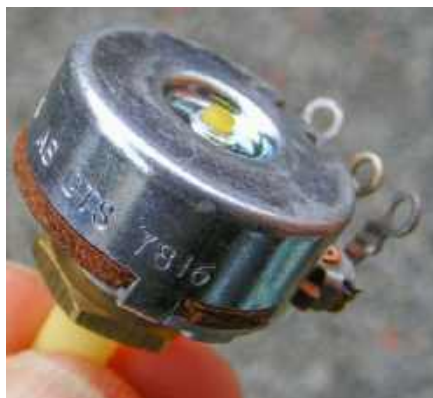
Rysunek 39. Model AB CTS (nie mylić z Allen-Bradley) to solidny, klasyczny potencjometr ze ścieżką węglową, produkowany w Walii przez firmę Blore Edwards Ltd. Łatwo go rozpoznać po plastikowej zaślepce z tyłu obudowy.
