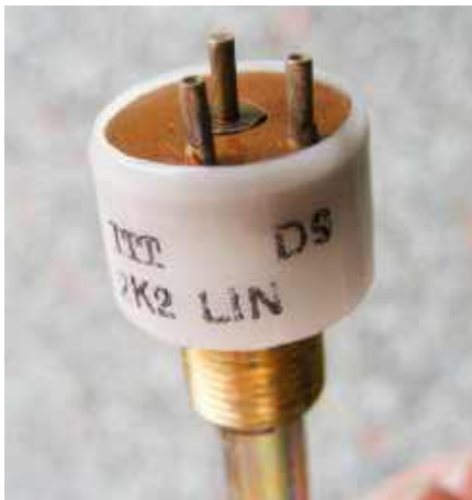
Rysunek 44. Potencjometr Erie ze ścieżką węglową formowaną na gorąco jest jednym z nielicznych wczesnych modeli zaprojektowanych z myślą o małym poziomie szumów. Używałem go w swoich efektach gitarowych bez żadnych problemów.
