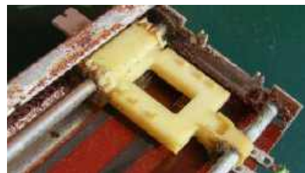
Rysunek 27. Typowe zanieczyszczenia znajdujące się na suwaku, które należy usunąć.
