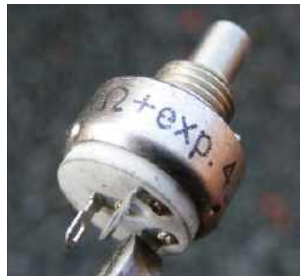
Rysunek 46. Bardzo mały potencjometr Ruwido. Ze względu na ceramiczne podłoże wygląda jak potencjometr cermetowy, ale w rzeczywistości ma węglową ścieżkę oporową i węglowy suwak.
