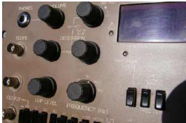
Rysunek 13. Ten stary analizator audio Wayne Kerr AMS1 miał problem z szumiącymi potencjometrami i trzeszczącymi przełącznikami.
