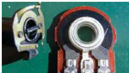
Rysunek 16. W starszych potencjometrach Radiohm/Omeg P20 (sprzed 1993 r.) zespół środkowego pierścienia ślizgowego był szczególnie podatny na trzaski z powodu zastosowania różnych metali.
