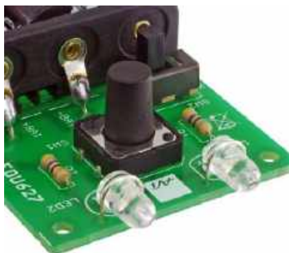
Fotografia 3. Krytyczne elementy (diody LED) przytwierdzone do PCB obejmą z drutu
