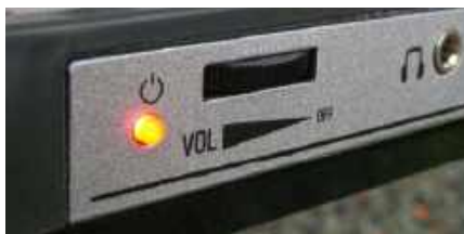
Rysunek 24. Ten niewielki potencjometr krawędziowy z wyłącznikiem zastosowałem w swoim projekcie syntezatora. Później przysporzył mi wielu problemów. W swoich projektach stosujcie dobre potencjometry obrotowe i oddzielne wyłączniki zasilania.
