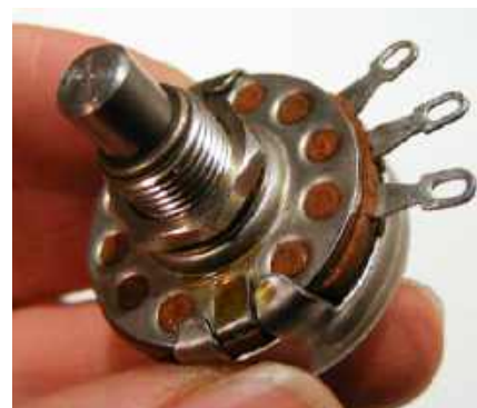
Rysunek 36. Potencjometry serii J firmy Allen-Bradley należą do najtrwalszych dostępnych konstrukcji. Charakteryzują się bardzo małym poziomem szumów dzięki wypolerowanej ścieżce oporowej. Nigdy nie musiałem ich wymieniać – przeciwnie, często wymontowywałem je ze starych urządzeń, aby wykorzystać je ponownie.
