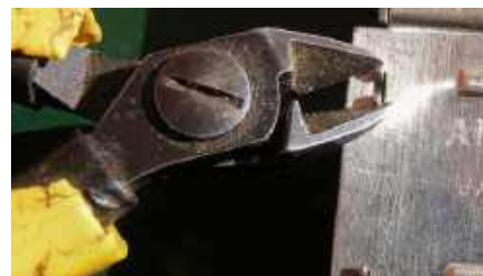
Rysunek 26. Demontaż potencjometru suwakowego Alps w celu jego wyczyszczenia. Ściśnij zatrzaski, aby zdjąć boczną osłonę.
