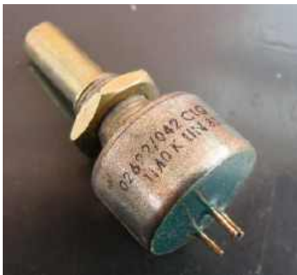
Rysunek 43. Potencjometr Citec/Plessey CLQ ze ścieżką węglową formowaną na gorąco jest stosowany w lotnictwie. Jest bardzo drogi, ale również bardzo wytrzymały. Istnieje także wersja cermetowa MCU/1, która nie nadaje się do regulatorów głośności.
