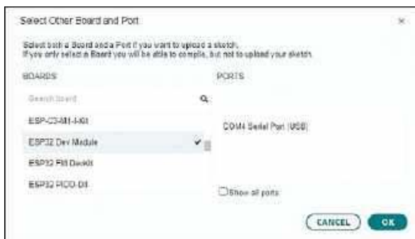
Rysunek 1.14. Wybór płytki i portu szeregowego.
