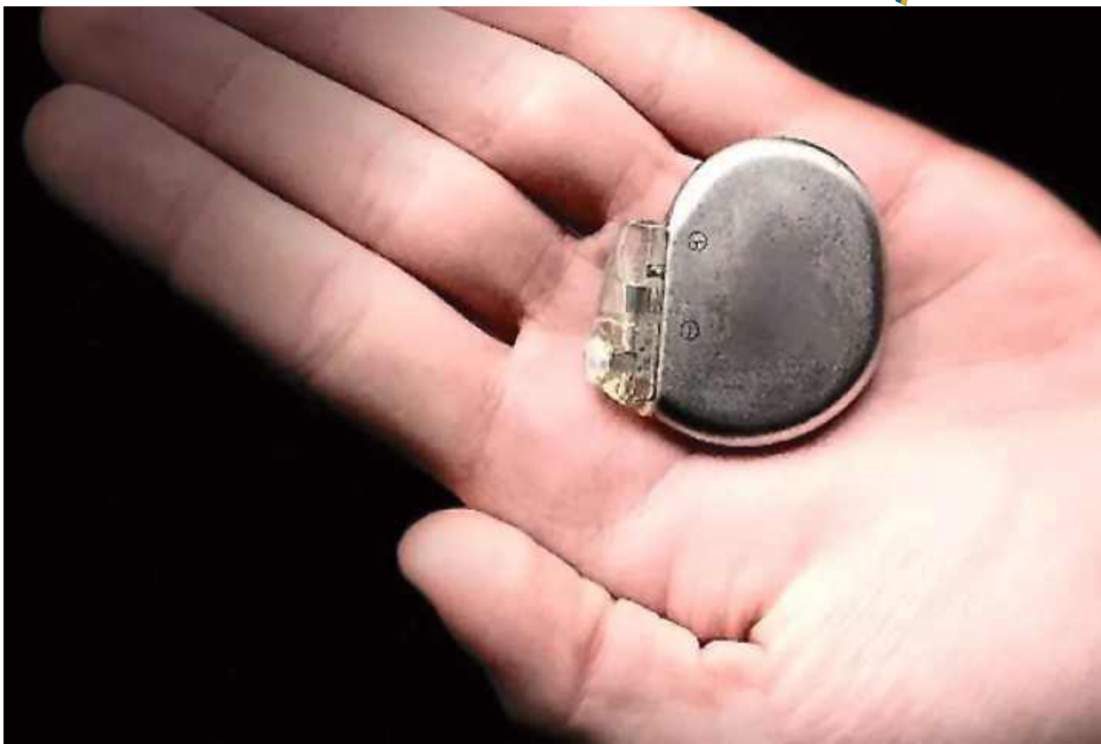
Puszka stymulatora na dłoni autora. W tym małym urządzeniu znajduje się bateria, działająca nawet kilkanaście lat!
