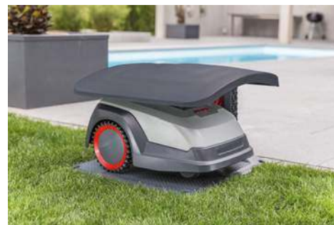
Roboty koszące można dowolnie programować. W odpowiednim momencie urządzenie wraca do stacji dokującej w celu doładowania akumulatora. Niektóre kosiarki radzą sobie z większym terenem, nachyleniem i mogą pracować podczas deszczu.
