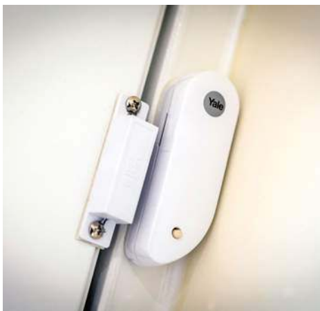
🔊 Na oknach i drzwiach montuje się czujniki kontaktronowe, które sygnalizują otwarcie stolarki. YALE, SATEL
