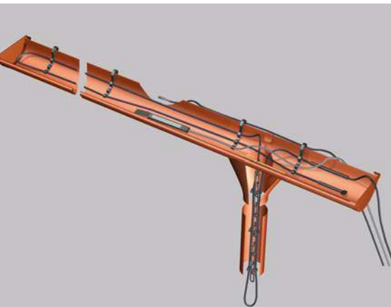
❗ Przewody grzejne układa się w rynnach i na całej długości rury spustowej. FENIX POLSKA
