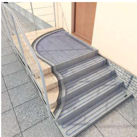
❗ Na schodach przewody montuje się tylko na ich poziomych powierzchniach. ELEKTRA
