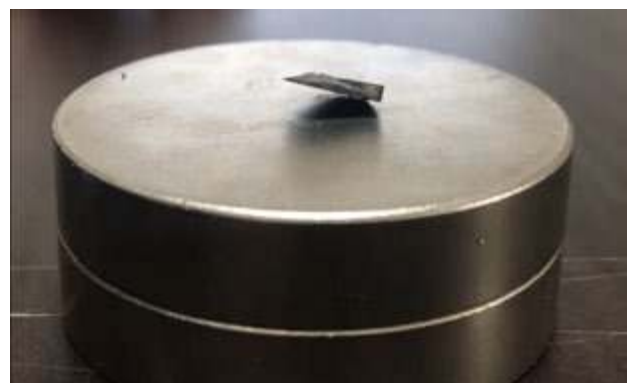
Rys. 5. Chłodzony ciekłym azotem magnes lewitujący nad nadprzewodnikiem wysokotemperaturowym, źródło: [7].
