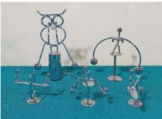
Fig. 6. Porównanie okresów drgań wahadeł fizycznych o podobnych masach, ale różniących się momentem bezwładności i „długością” d wahadła, (a) PED-y z niklowanego drutu z Berlina, (b) „Pieski kiwaczki”. Zob. filmy na dydaktyka.fizyka.umk.pl/FwSzkole/pieski1 (1a, 1b, 2, 2a, 2b).
