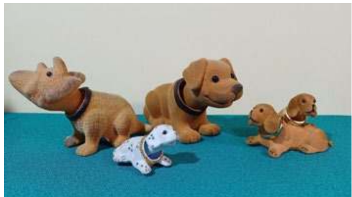
Fig. 6. Porównanie okresów drgań wahadeł fizycznych o podobnych masach, ale różniących się momentem bezwładności i „długością” d wahadła, (a) PED-y z niklowanego drutu z Berlina, (b) „Pieski kiwaczki”. Zob. filmy na dydaktyka.fizyka.umk.pl/FwSzkole/pieski1 (1a, 1b, 2, 2a, 2b).
