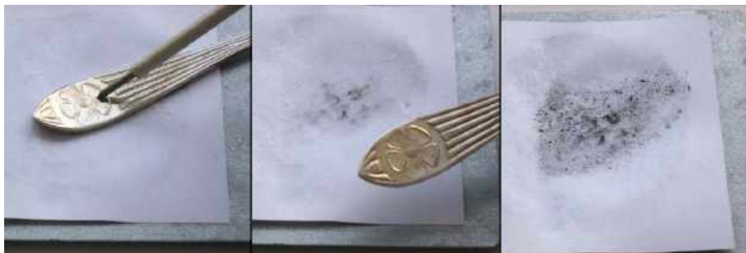
5. Analiza elektrograficzna srebra na bibule nasączonej roztworem chlorku sodu: pod wpływem światła słonecznego niktą ślad po badaniu szybko ciemnieje
