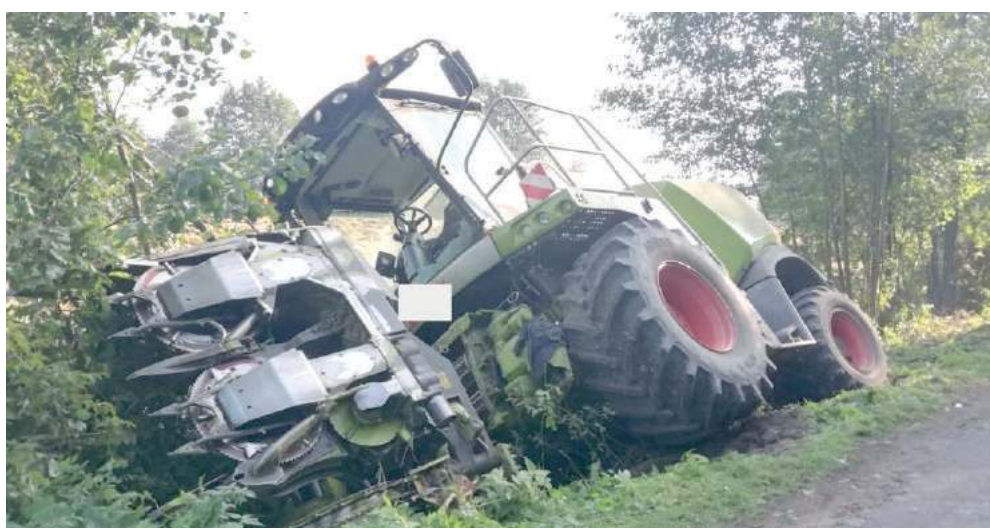
W trakcie wymijania kierowca zjechał na pobocze, gdzie nieutwardzony teren pod naporem ciężkiego urządzenia obsunął się i sprzęt wyładował w rowie
