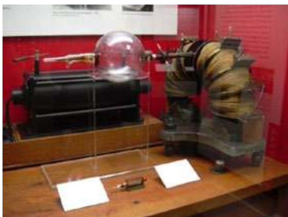
Ryc. 1. Originalne przyrządy, na których dokonano epokowych odkryć w fizyce (i chemii) w kolekcji Science Museum w Londynie w 2003 roku. (a) Spektrometr masowy Astona z 1919 roku, za pomocą którego odkrył on dwa stabilne izotopy neonu. (b) Przyrządy do badań nad sztuczną (tzn. indukowaną) radioaktywnością, które w 1940 roku małżeństwo Joliot-Curie przewiozło do Anglii. Zdjęcia (GK) są, niestety, nieostre i niedoświetlone: ot! początki fotografii cyfrowej.
