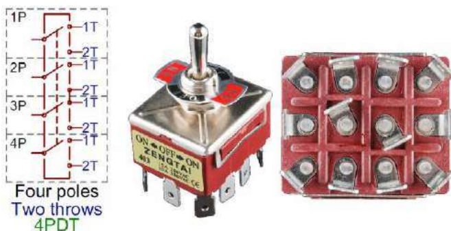
Rysunek 4. Schemat ideowy i przykładowy przełącznik 4PDT
