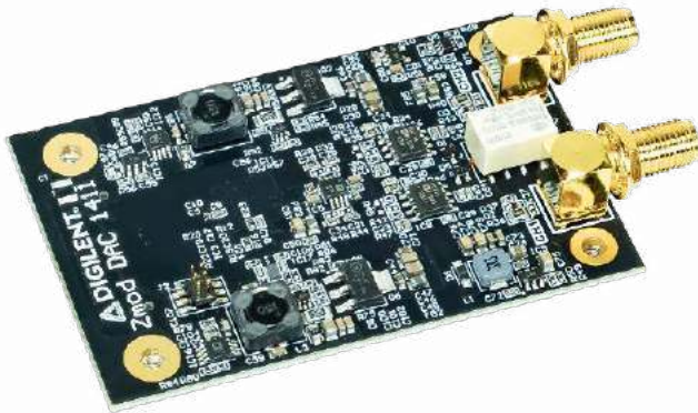
Fotografia 2. Wygląd dwukanałowego przetwornika C/A Zmod DAC 1411 ze złączem SYZYGY
