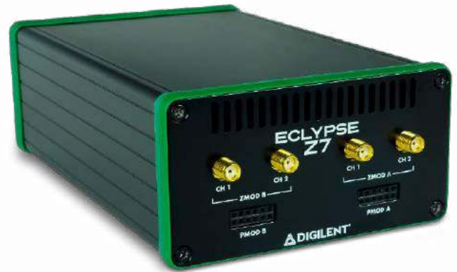
Fotografia 4. Zestaw Digilent Eclipse Z7 z przetwornikami Zmod ADC 1410 i Zmod DAC 1411 zamontowane w dedykowanej obudowie
