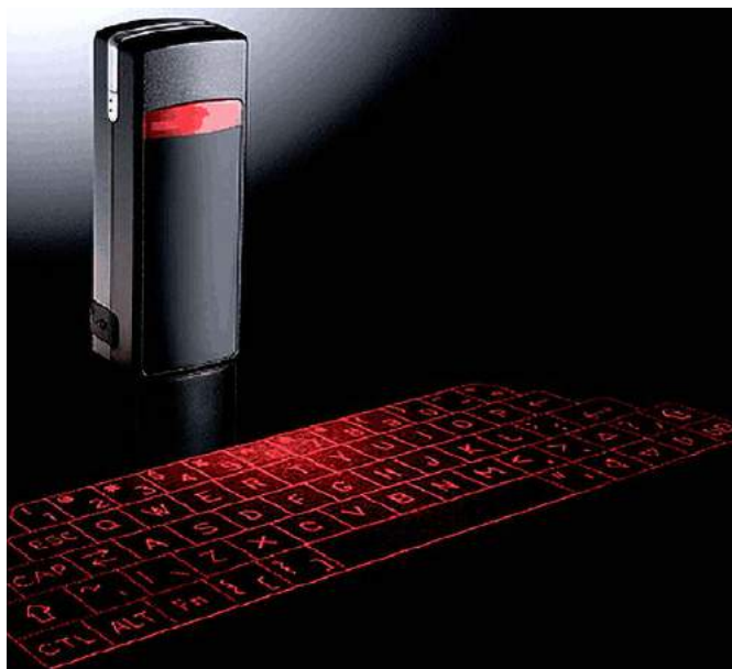
Fotografia 4. Klawiatura wyświetlana przy pomocy lasera
