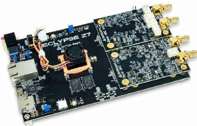
Fotografia 3. Wygląd zestawu Digilent Eclipse Z7 z zamontowanymi przetwornikami A/C i C/A w złączach SYZYGY
