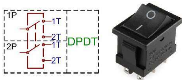
Rysunek 3. Schemat ideowy przełącznika DPDT i przykładowy przełącznik kotłuszkowy tego rodzaju
