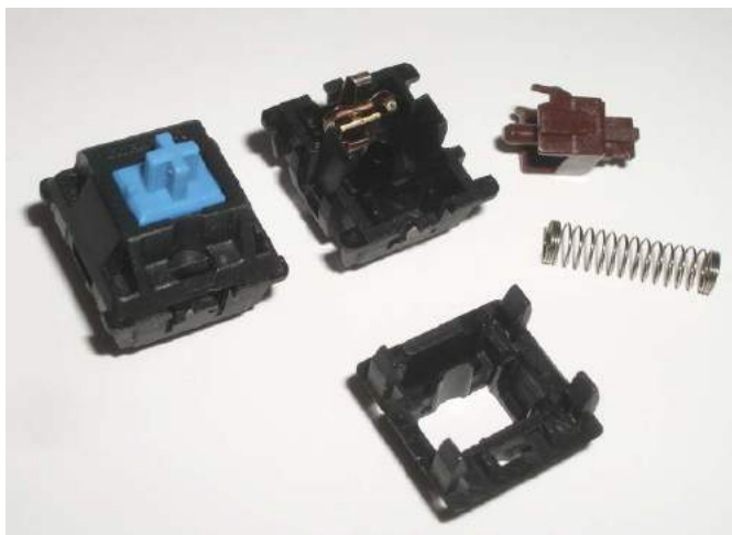
Fotografia 2. Przykładowe przyciski mechaniczne do klawiatur: Cherry MX Blue (zamknięty) oraz Cherry MX Brown (otwarty), różniące się typem i siłą aktywacji
