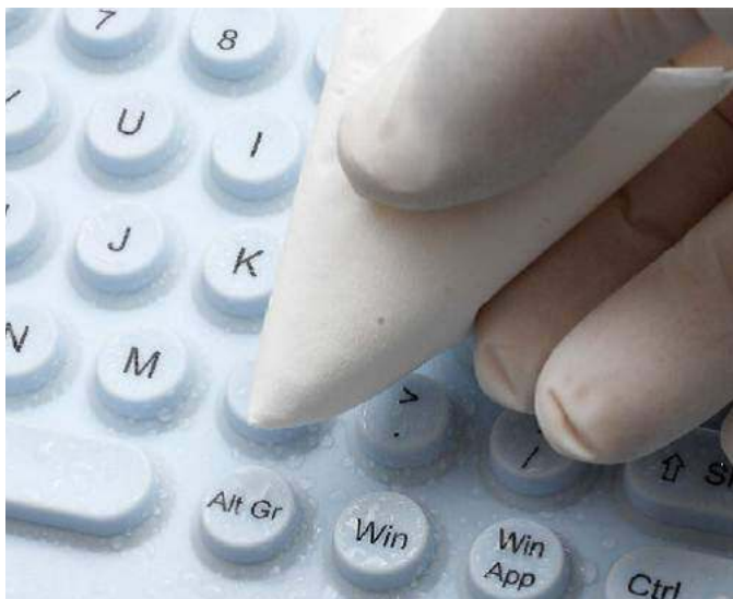
Fotografia 2. Klawiatura silikonowa wymaga zachowania dużej staranności przy usuwaniu zanieczyszczeń z zakamarków pomiędzy klawiszami
