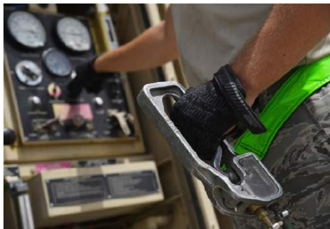
Fotografia 6. Czuwak nalewaka paliwa, obsługiwany przez żołnierza tankującego samolot w amerykańskiej bazie w Azji
