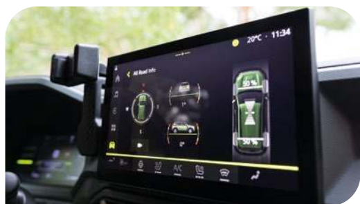
Na 10-calowym ekranie komplet informacji dla kierowcy – w tym także te dotyczące napędu 4x4 oraz aktualnych kątów ustawienia auta
