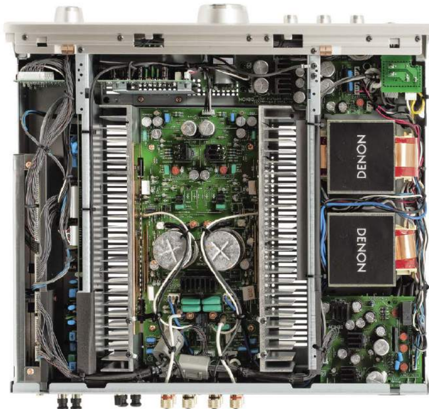
Zaawansowane wzmacniacze Denona imponują starannym rozplanowaniem wnętrza; PMA-1700NE to konstrukcja dual mono.
