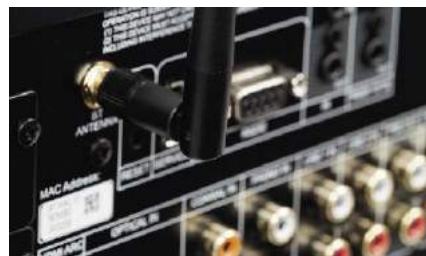
Już w „standardzie” wzmacniacz ma system Bluetooth z transmisją dwukierunkową i kodowaniem aptX HD.
