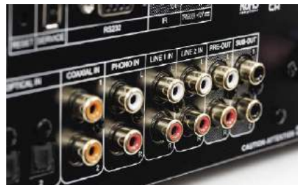
Panel analogowy wygląda dość skromnie, ale jest w nim wejście gramofonowe (MM).
