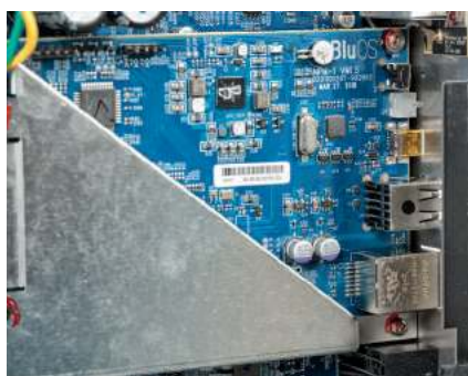
Dolna płyta to projekt Rokšana, zgromadzono tutaj dużą część układów cyfrowych, a także odbiornik Bluetooth.
