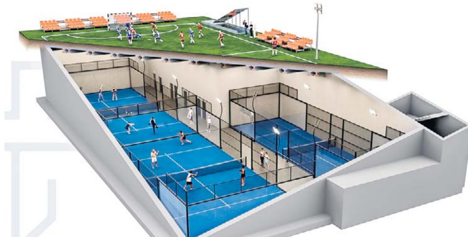
ORLIK S-1 to schron kategorii S-1 dla 750 osób zaprojektowany pod standardowym boiskiem szkolnym o wymiarach 20x40 metrów
