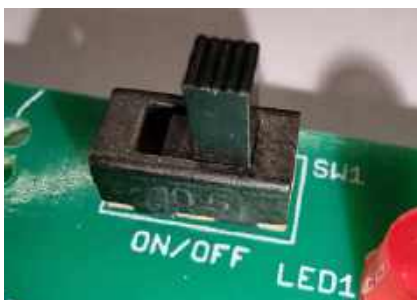
Fotografia 11. Montaż przełącznika umożliwiającego galwaniczne odłączenie baterii od układu elektronicznego
