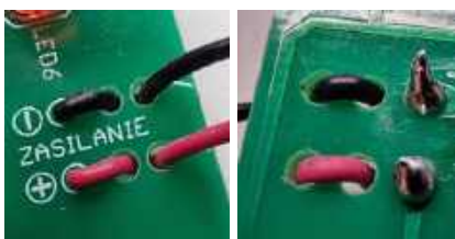
Fotografia 12. Sposób montażu kabelków koszyeczka baterii do płytki PCB. Przed przylutowaniem kabelków do płytki należy przewlec je przez otwory mechanicznie je stabilizujące. Dzięki takiemu rozwiązaniu połączenie będzie trwalsze i kabelków nie będzie się dało tak łatwo oderwać od płytki
