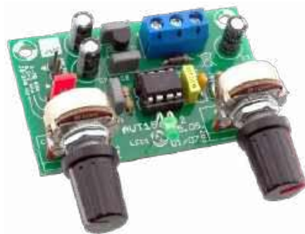
AVT1569 Generator akustyczny 20 Hz...20 kHz https://sklep.avt.pl/avt1569.html
