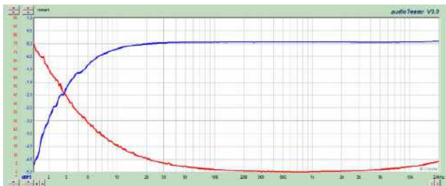
10. Pasmo przenoszonych częstotliwości: linia niebieska – charakterystyka amplitudowo-częstotliwościowa, linia czerwona – charakterystyka fazowo-częstotliwościowa, 15 V RMS na obciążeniu rezystancyjnym 8 \Omega
