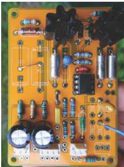
Rysunek 12. Zmontowany wzmacniacz wyjściowy. Jest to w zasadzie wzmacniacz sumujący z dodatkowym bocznikiem R_{SENSE} (prawy dolny róg płytki) i tantalowym kondensatorem sprzęgającym (biegun ujemny w stronę układu scalonego) zamiast rezystora R4. Sygnał zwrotny z transformatora wchodzi do otworu dla rezystora R2 przy biegunie dodatnim kondensatora
