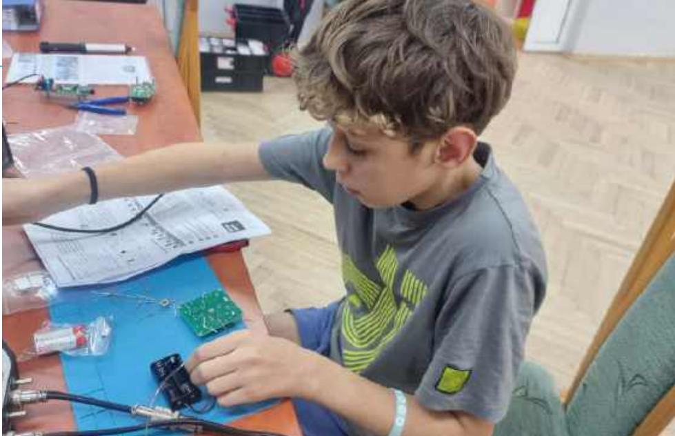
Fotografia 2. Kacper lutuje kolejno osadzone w płytce rezystory. Młodzi Entuzjaści Elektroniki, Szkoła Podstawowa nr 86, Wrocław
