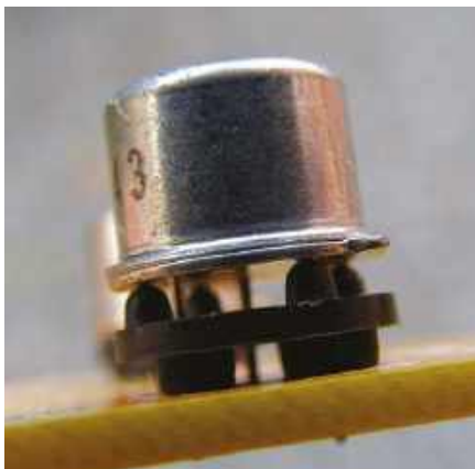
Rysunek 18. Plastikowa podkładka montażowa pod tranzystor w obudowie TO5
