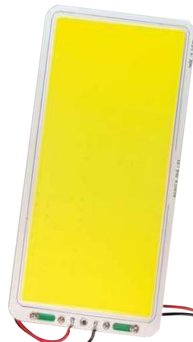
Rysunek 1. Tak, jak w przypadku każdej diody półprzewodnikowej, prąd płynący przez panele LED zmienia się gwałtownie wraz ze zmianami napięcia. W związku z tym regulacja jasności panelu poprzez sterowanie napięciem jest niepraktyczna. Zamiast tego musimy regulować natężenie prądu, co jest jedną z funkcji sterownika LED
