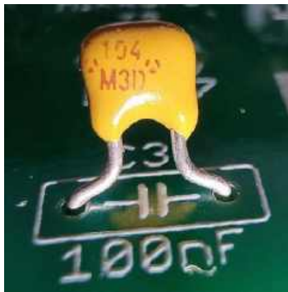
Fotografia 6. Montaż kondensatora stałego C3. Kierunek montażu jest obojętny. Na obudowie kondensatora widać napis „104” informujący o pojemności 10 i 4 zera pikofaradów (100000 pF) czyli 100 nF
