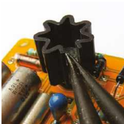
Rysunek 19. Mocowanie radiatora na obudowie TO5 z pomocą cążek
