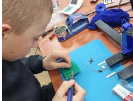
Fotografia 8. Kornel zdecydował się rozpocząć montaż od tranzystorów. Tak też można. Młodzi Entuzjaści Elektroniki, Szkoła Podstawowa nr 86, Wrocław
