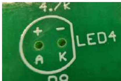
Fotografia 4. Oznakowanie otworów przeznaczonych do zamontowania diod LED na płytce drukowanej
