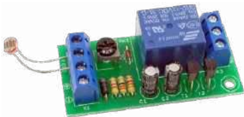
AVT1476 Automacyjny włącznik zmierzchowy https://sklep.avt.pl/avt1476.html
