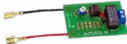
AVT1533 Zabezpieczenie akumulatora 12 V przed rozładowaniem https://sklep.avt.pl/avt1533.html
