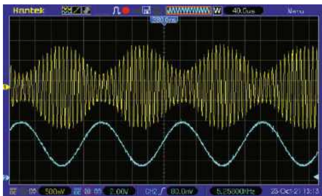
Rysunek 3. Sygnał wyjściowy 100 kHz z AM 5 kHz (żółty). Sygnał wyjściowy AM z AD9833 jest pokazany poniżej (cyjan)
