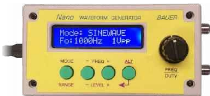
Rysunek 4. Panel przedni prototypu Autora z wyświetlaczem, przyciskami i potencjometrem
