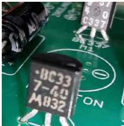
Fotografia 7. Montaż tranzystorów T1 i T2. Oba tranzystory są tego samego typu. Korpusy tranzystorów (w kształcie litery „D”) odpowiadają obrysom (również w kształcie litery „D”) na warstwie opisowej płytki PCB
