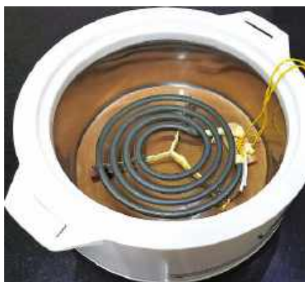
Rysunek 8. Spirala grzejna umieszczona wewnątrz naczynia żaroodpornego na okrągłej podkładce teflonowej
