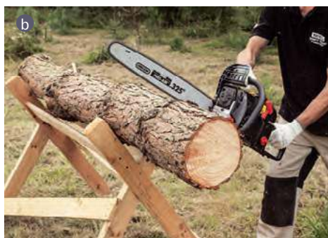
P ilarka łańcuchowa elektryczna (a) i spalinowa (b). Urządzenia wyglądają podobnie, ale mają inną specyfikę. Te pierwsze są lżejsze, cichsze, bardziej ekologiczne i prostsze w obsłudze. Urządzenia spalinowe są głośniejsze, dymią i silniej wibrują, ale za to mają większą moc. YATO
