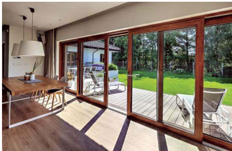
Wejście na taras składające się z czterech elementów na ogół wyposaża się w dwa skrajne skrzydła nieotwierane i dwa środkowe ruchome. MS WIĘCEJ NIŻ OKNA
