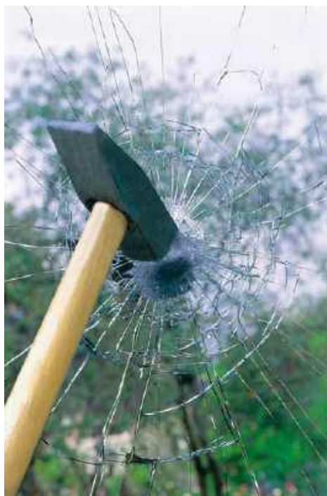
🔑 Antywłamaniowa szyba, nawet stłuczona, nie wypadnie z ramy. VETREX
