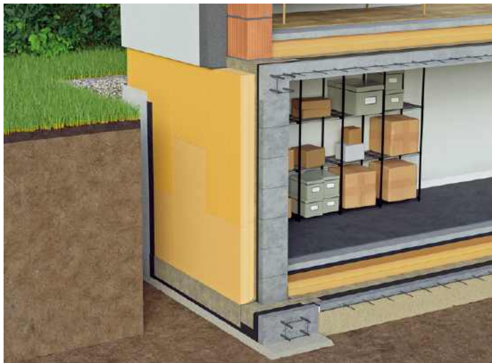
❗ Izolacja ułożona w ziemi jest narażona na ciągły kontakt z wilgocią i wodą gruntową. W takich warunkach dobrze sprawdza się XPS. SWISSPOR POLSKA
