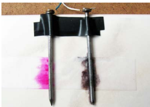
4. Charakterystyczne barwy fenolftaleiny i jodu w obecności skrobi pozwolą określić znaki biegunów źródła prądu stałego
