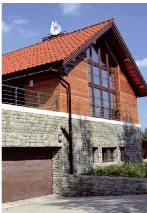
🔗 Kamień jest ciężki, dlatego na ogół wykańcza się nim grube ściany osłonowe albo konstrukcyjne bądź jedynie fragmenty przegród – cokoły, piwnice, garaże. L. JAMPOLSKA
