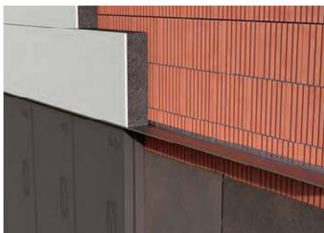
📌 Listwa startowa zabezpiecza od dołu pierwszy rząd ocieplenia ścian nadziemna. SWISSPOR
