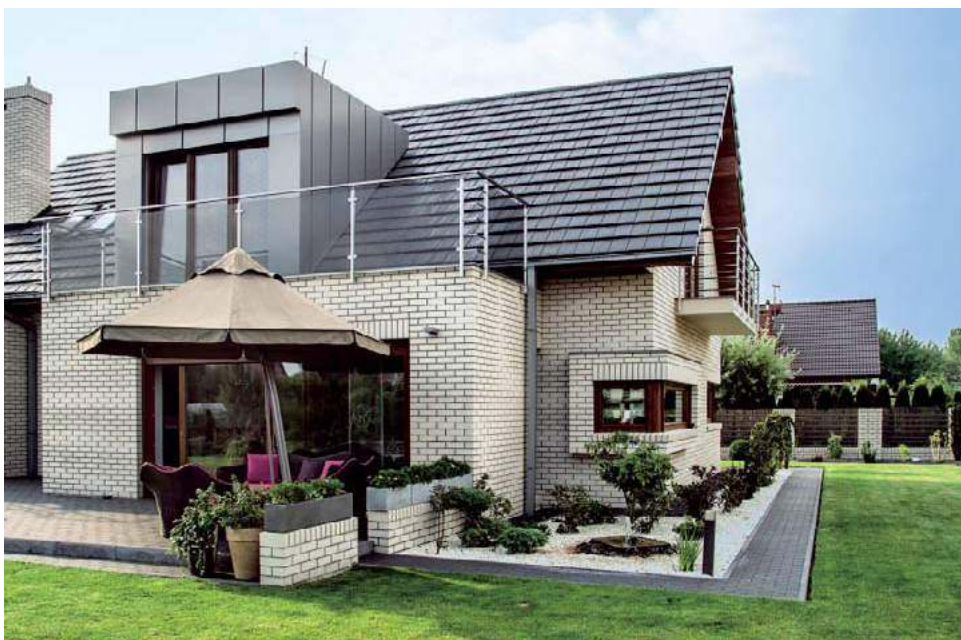
🔗 Elewacje wymurowane z cegieł klinkierowych na ogół stanowią ostatnią warstwę ścian stawianych w technologii trójwarstwowej. RÖBEN
