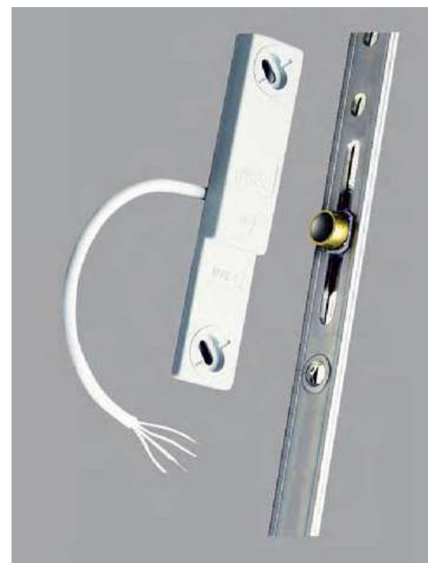
▲ Czujnik kontakttronowy składa się z dwóch elementów – magnesu, który zakłada się na skrzydle okna bądź drzwi i kontakttronu, montowanego na ościeżnicy. Oddalenie ich od siebie skutkuje uruchomieniem się alarmu. BUDVAR
