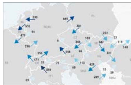
Rys. 1. Średni wskaźnik PTDF flow indicator dla roku 2023 [MW]. Źródło: ENTSO-E Bidding Zone Configuration Technical Report 2025 [4]
