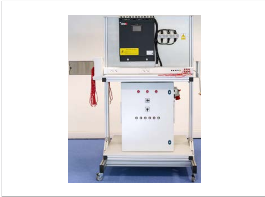
Rys. 2. Widok stanowiska szkoleniowego SVG z zainstalowanym kompensatorem SVG 10 kvar w wykonaniu tradycyjnym (z chłodzeniem mechanicznym)
