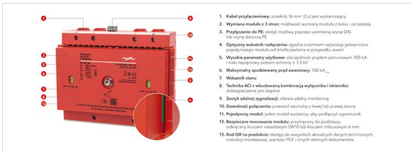
Rys. 3. Wygląd i charakterystyka ogranicznika przepięć DEHNventil ACI
