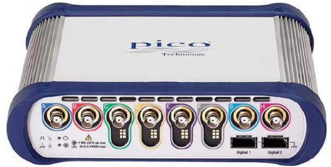
Fotografia 7. Oscyloskop PicoScope z serii 6000 z ośmioma kanałami analogowymi i opcją MSO
