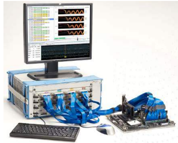
Fotografia 13. Rozbudowany system analizy sygnałów logicznych, oparty na modułach Keysight U4164A
