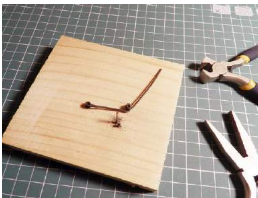
Fotografia 4. Z tym pomocnym przyrządem bez trudu formujemy druciane pętelki
