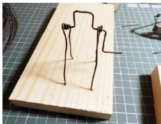
Fotografia 7. Pierwsza przymiarka korby i wykorbienia na jej wale
