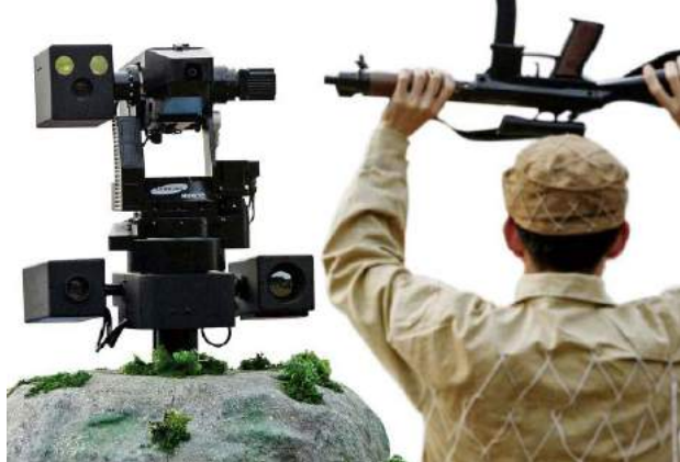
4. Demonstracja detekcji poddającego się żołnierza przez system SGR-1 Samsunga
