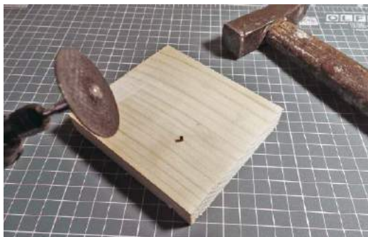
Fotografia 2. Powstaje przyrząd do nawijania pętelek drutu
