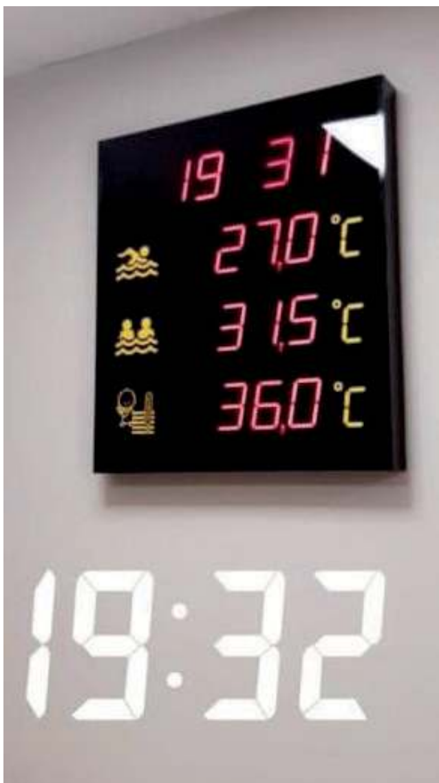
Temperatura wody w basenach pływackich i do nauki pływania powinna wynosić od 27 st.C do 28 st.C i tyle pokazuje termometr na basenie
