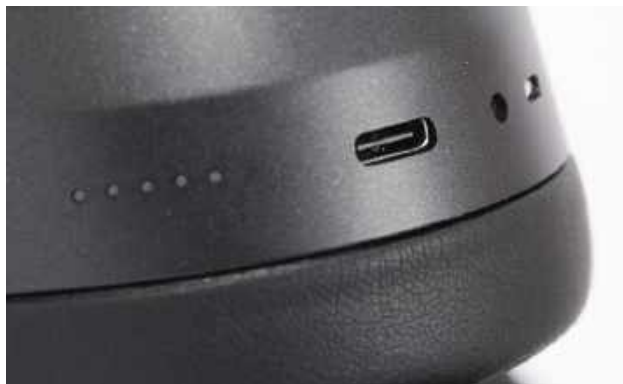
HDB 630 są wyposażone w uniwersalne gniazdo USB-C służące do ładowania, a także odbioru sygnału audio (również analogowego, gdy zastosujemy specjalny przewód – przejściówkę).
