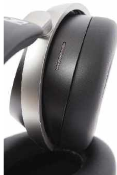
HDB 630 mają system ANC (i tryb przeźroczystości), w kilku miejscach muszli widać niewielkie szczeliny dla mikrofonów.
