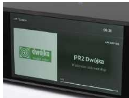
Node Icon wyposażono w 5-calowy kolorowy wyświetlacz, matryca nie jest jednak dotykowa.
