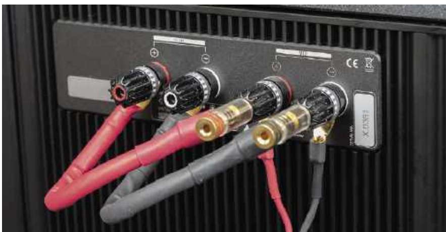
Górne pary zacisków łączymy zworami, a jedną z tych par – dłuższym kablem z parą na dole, do której najwygodniej będzie podłączyć kabel ze wzmacniacza.
