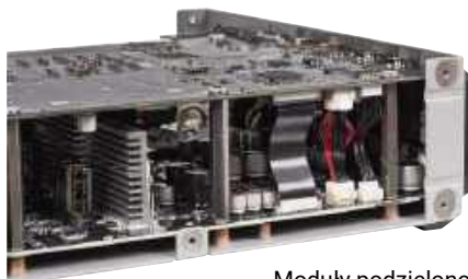
Moduły podzielono pod kątem różnych funkcji i zastosowań, jedno z pięter zajmują cyfrowe układy DSP.
