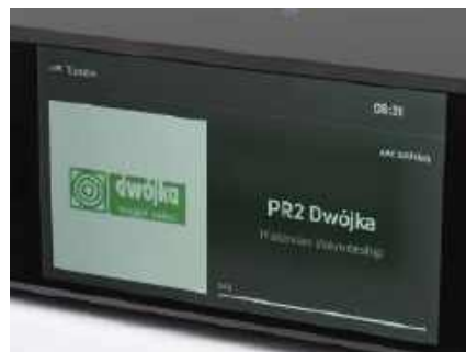
Node Icon wyposażono w 5-calowy kolorowy wyświetlacz, matryca nie jest jednak dotykowa.
