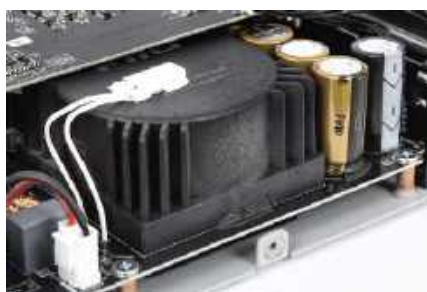
Zasilacz jest liniowy; technicznie to bardzo audiofilskie urządzenie.
