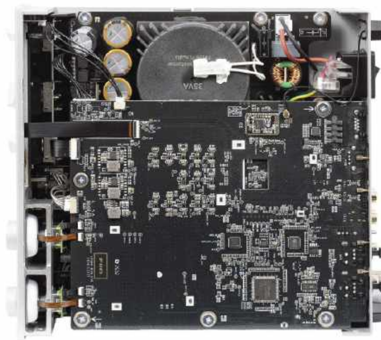
Moduły podzielono pod kątem różnych funkcji i zastosowań, jedno z pięter zajmują cyfrowe układy DSP.
