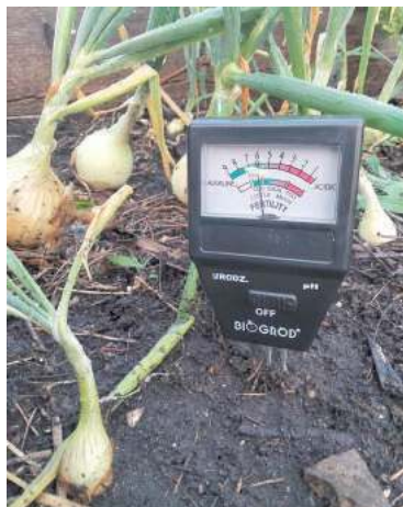
Kwasomierz to bardzo przydatne urządzenie. Możemy nim w bardzo prosty sposób sprawdzić pH gleby.
