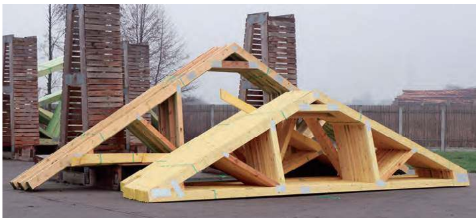
🔧 Wiązary wykonuje się nie na budowie, a w zakładzie produkcyjnym. Jedną z ich największych zalet jest bardzo szybki montaż – specjaliści mogą się z nim uporać nawet w jeden dzień. WIĄZARY BURKIETOWICZ
