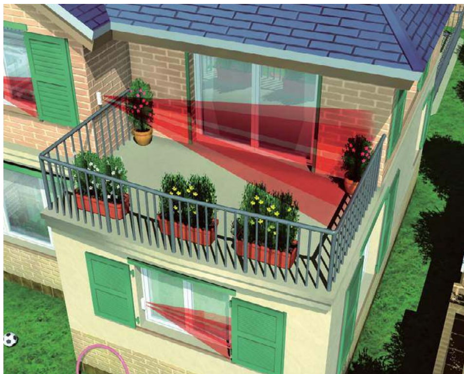
➊ Zewnętrzne czujki ruchu i kurtyny podczerwieni bardzo poprawiają bezpieczeństwo, bo wykrywają intruza jeszcze zanim wejdzie do budynku. Jednak są to drogie elementy. OPTEX SECURITY
