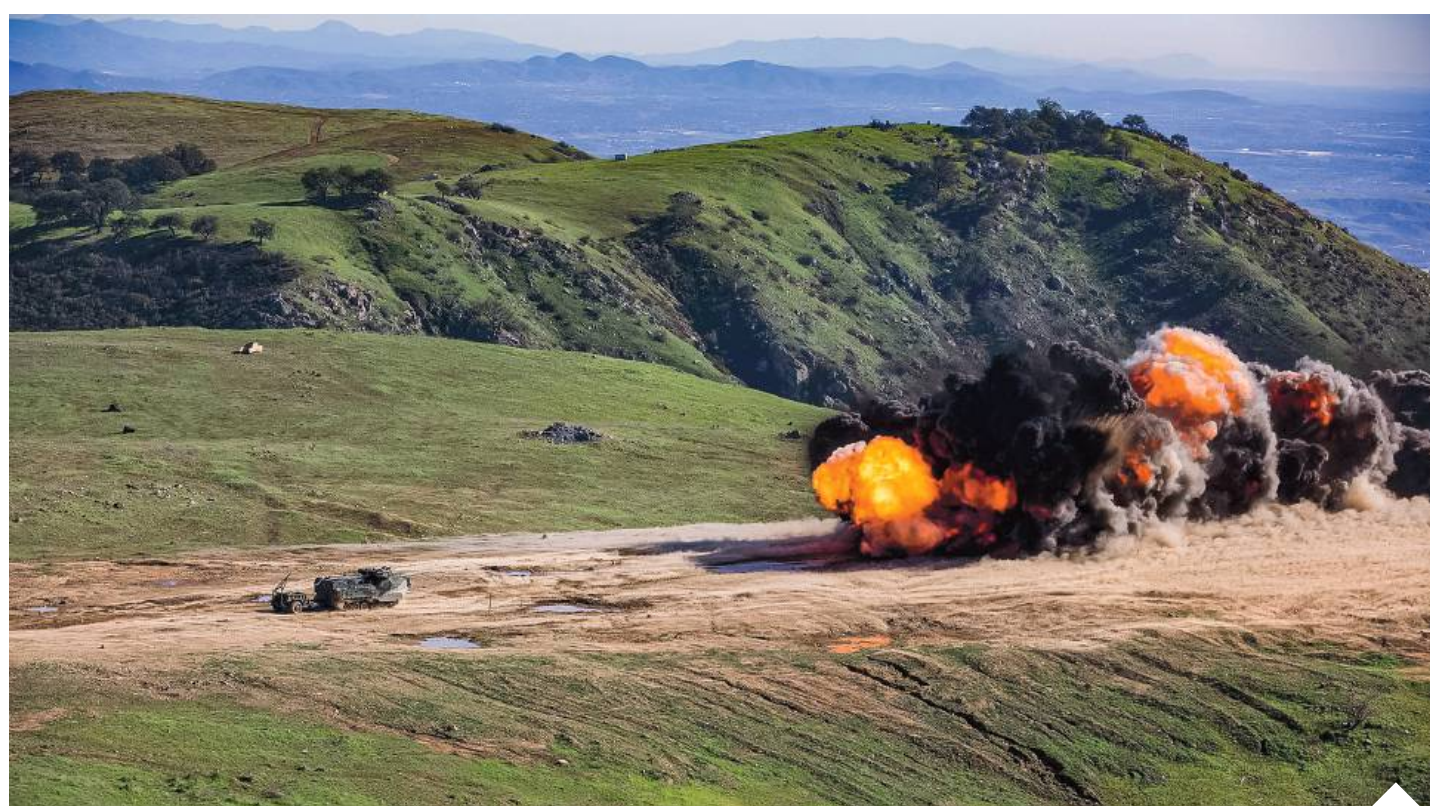
USA dostarczyły Ukrainie system M58 Mine Clearing Line Charge, który umożliwia oczyszczenie obszaru z min przeciwpancernych i przeciwpiechotnych oraz improwizowanych ładunków wybuchowych | fot. Wikipedia/d
