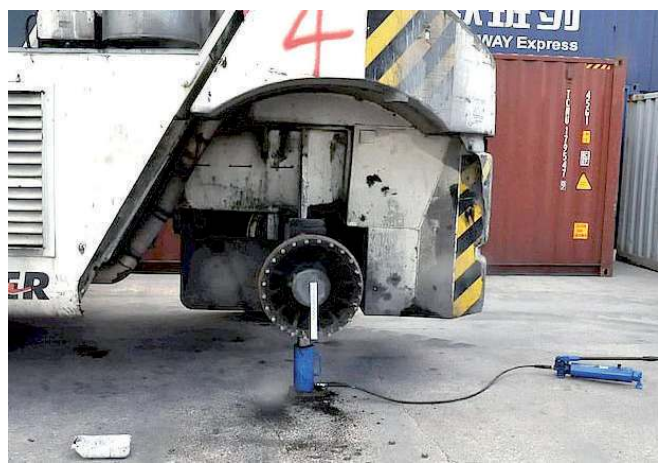
Mężczyzna wymieniał koła w maszynie służącej do podnoszenia i przewożenia kontenerów kolejowych
