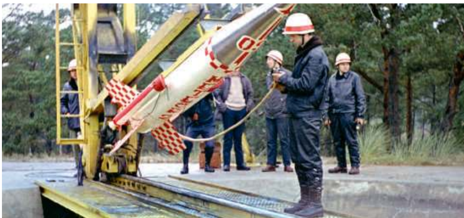
Wyrzutnia polskich rakiet na Mierzei Łebskiej. Przed startem sondy Meteor 2K Tadeusz Andrzejewski podłącza kabel zasilający.
