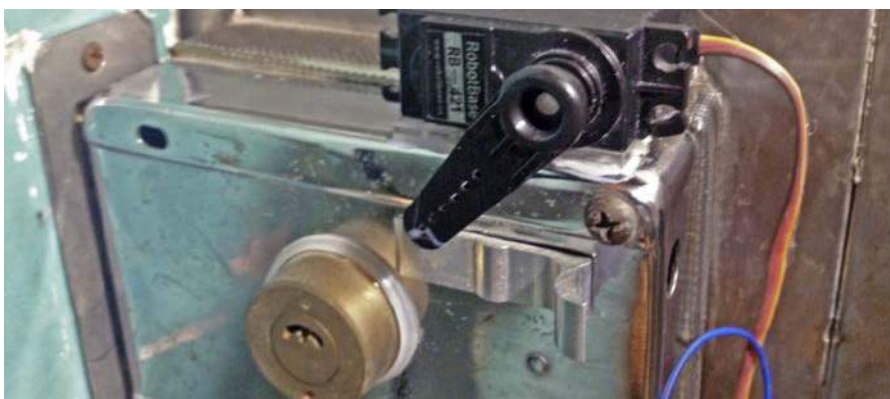
Fotografia 4. Sposób zamontowania serwomechanizmu do zamka
