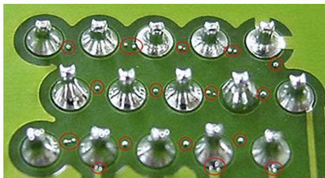
Fotografia 21. Kulczowanie – defekt powstający podczas lutowania z użyciem pasty lutowniczej
