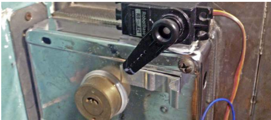
Fotografia 4. Sposób zamontowania serwomechanizmu do zamka
