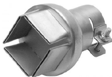
Fotografia 18. Specjalna dysza kierująca strumień powietrza tylko na wyprowadzenia układu w obudowie QFP
