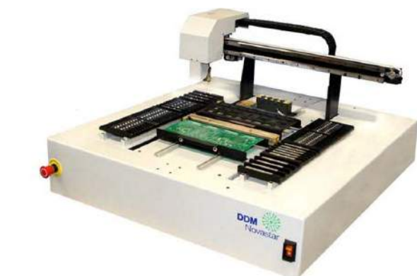
Fotografia 7. Urządzenie do układania elementów na płytce PCB (pick &amp; place)
