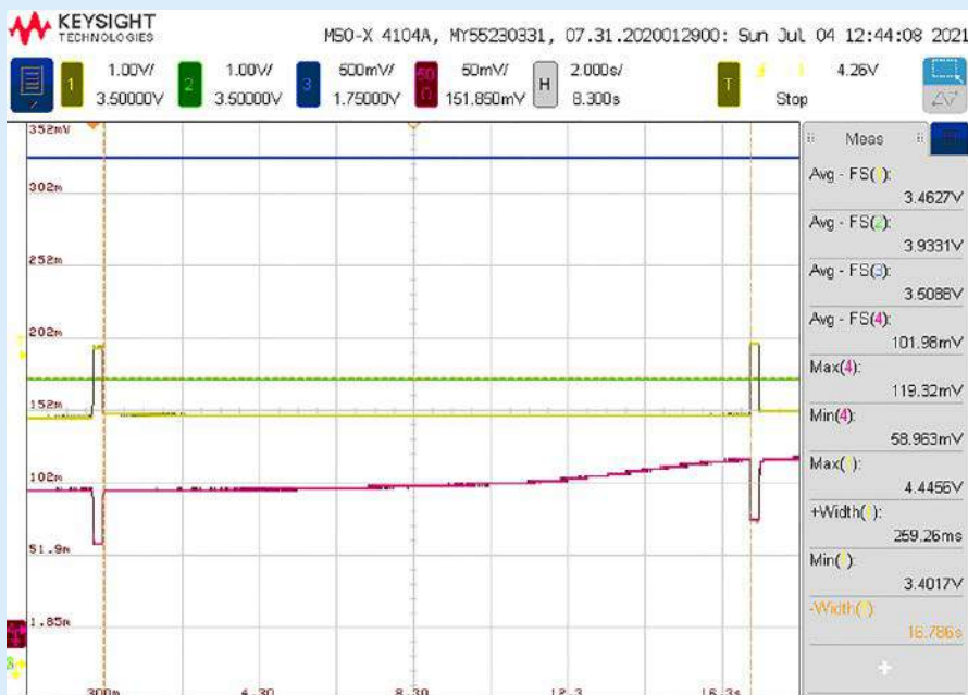
Rysunek 5. Praca modułu CJMCU-2557 z układem BQ25570
