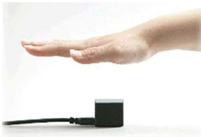
Fotografia 6. Bezdotkowy, biometryczny skaner unaczynienia marki iDentyTech, źródło: https://identitytech.com/palm-vein-recognition
