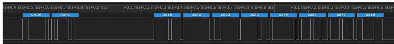
Rysunek 1. Ramka z zapytaniem odbiornika i odpowiedzią czujnika napięcia FLVSS
