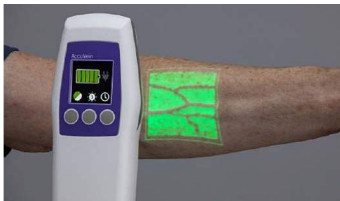
Fotografia 7. Lokalizator żył wykorzystujący technikę obrazowania IR analogiczną do tej, z której korzystają niektóre systemy identyfikacji biometrycznej, źródło: https://bit.ly/3rd6AoZ
