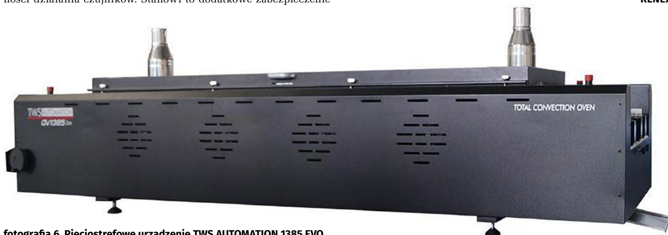
Fotografia 6. Pięciostrefowe urządzenie TWS AUTOMATION 1385 EVO
