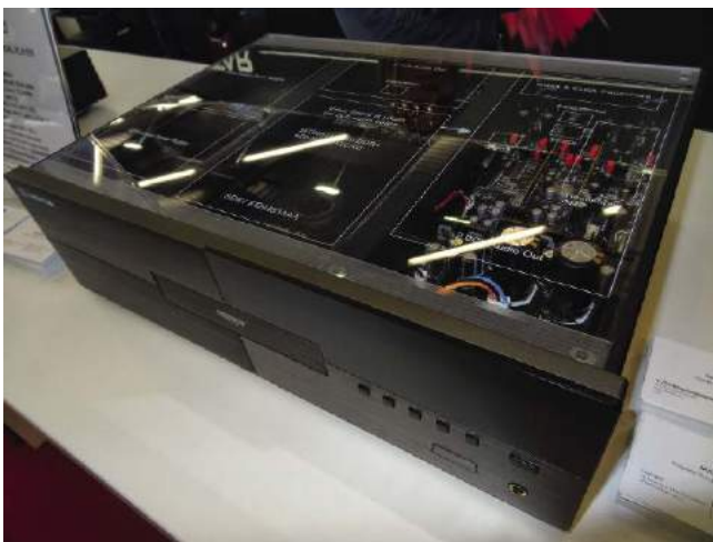
Wysokiej klasy odtwarzacze Blu-Ray stały się rzadkością, są więc poszukiwane może przez niewielką, ale zdesperowaną grupę zainteresowanych. Magnetaur UDP-900 to maszyna wyjątkowo solidna, o czym świadczy już jej masa – ponad 15 kg. Zostawiając na boku jej talenty wideo, może ona zainteresować również posiadaczy kolekcji płyt audio różnych formatów. Zainstalowany DAC jest bardzo obiecujący – ES9030PRO, sygnał stereo wyciągniemy z pary RCA lub XLR, a wielokanałowy – z kompletu 7.1.
