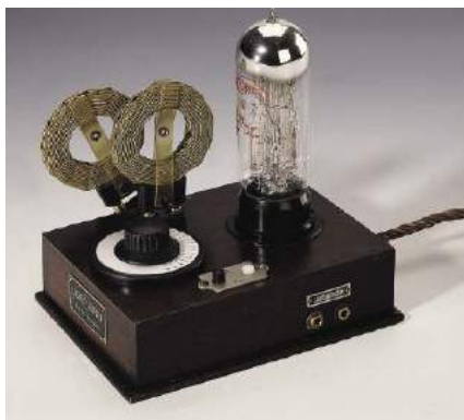
Odbiornik radiowy OE333 – rodzynek w historii audio, z potrójną triodą i anteną na wierzchu.
