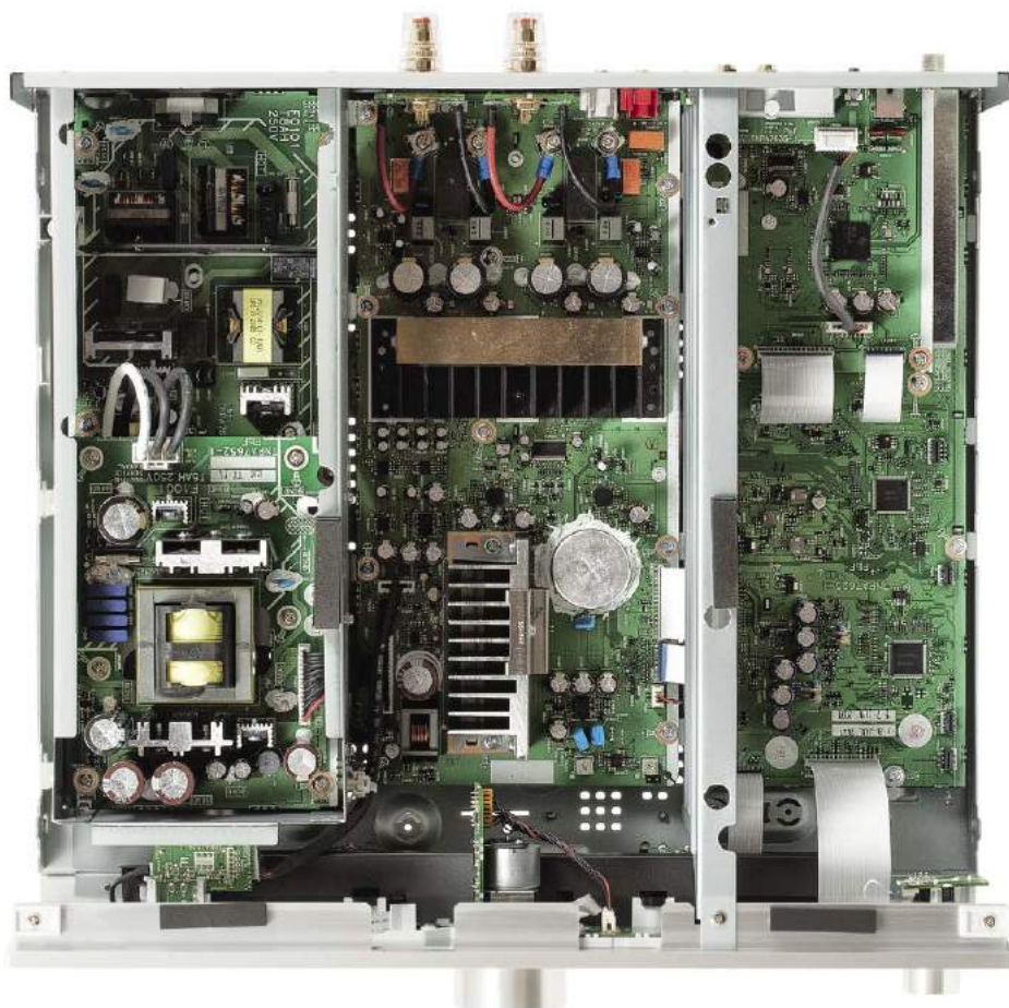
Wnętrze zaaranżowano w trzech głównych komorach – dla przedwzmacniacza, końcówki mocy oraz zasilacza
