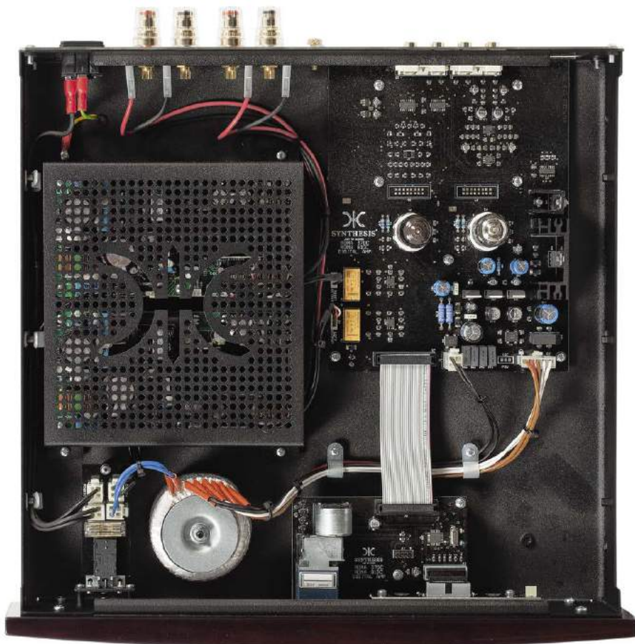
Niewielki transformator toroidalny obsługuje wyłącznie obwody przedwzmacniacza oraz sterowania.
