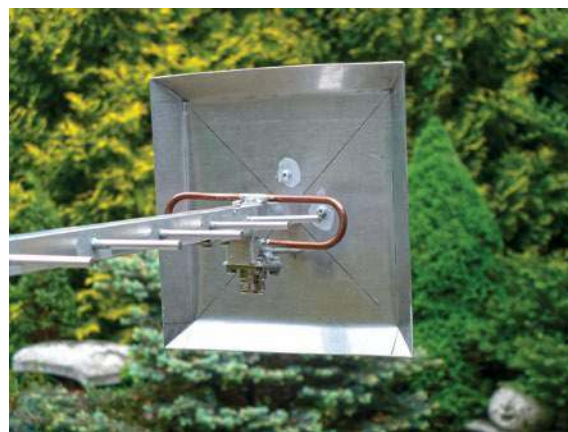
Rys. 2. Sposób wykonania baluna (transformatora) na pasmo 23 cm
