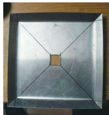
Rys. 1. Sposób wykonania wibratora (R) na pasmo 23 cm
