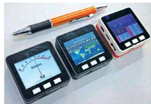
Fot. 3. Niektóre projekty oparte na mikrokomputerze M5Stack. Od lewej do prawej: miernik siły sygnału dla IC-705, wyświetlacz informacji DX-owych i pulpit informacyjny sieci RRF
