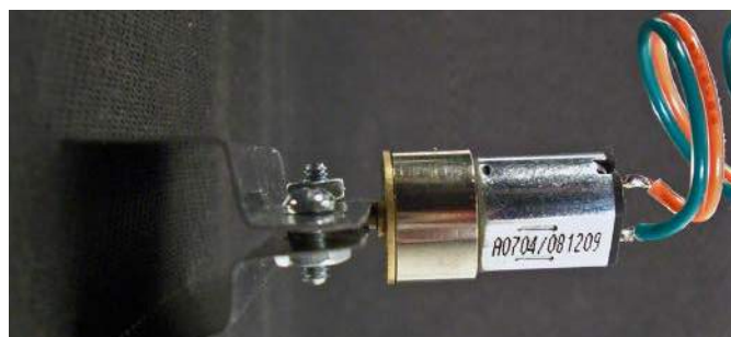
Fotografia 2. Uchwyt zamka zamontowany do osi silnika
