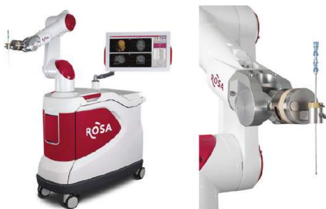
Fotografia 23. Robot neurochirurgiczny ROSA, przeznaczony głównie do biopsji mózgu, neuroendoskopii oraz wspomagania implantacji elektrod do głębokiej stymulacji mózgu ( https://t.ly/dZFlu )
