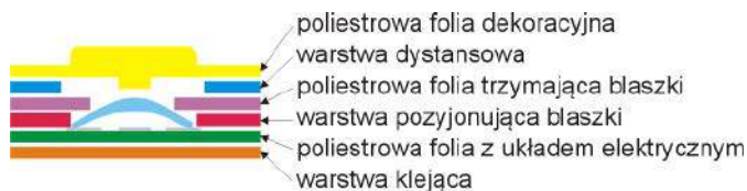
Rysunek 5. Przekrój klawiatury z przyciskami silikonowymi
