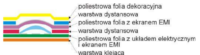
Rysunek 4. Przekrój klawiatury z ekranem EMI/RFI
