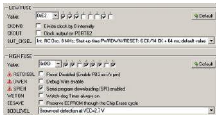
Rysunek 4. Szczegóły ustawienia bitów zabezpieczających
