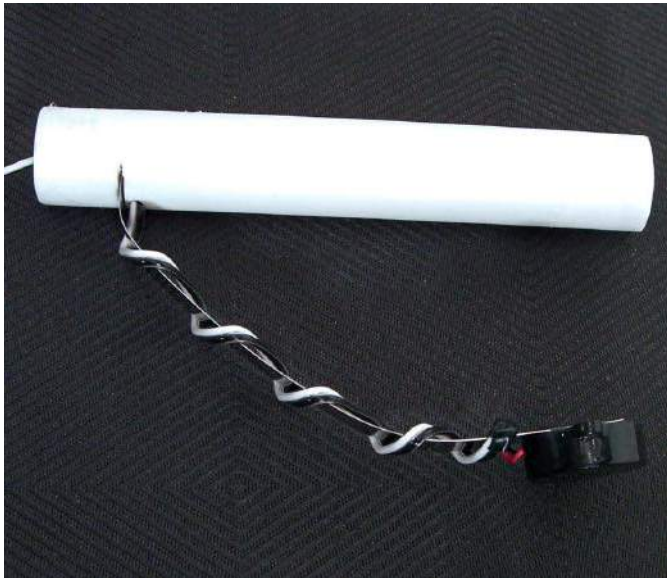
Fotografia 3. Detektor zainstalowany na sprężynie dociskowej
