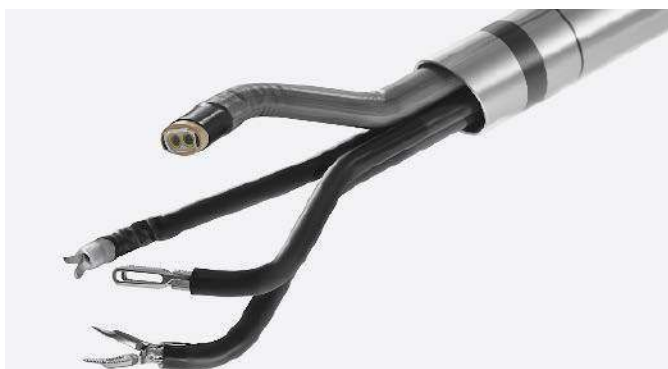
Fotografia 6. Głowica narzędziowa robota da Vinci SP – widoczna stereoskopowa kamera z oświetlaczem (na górze) oraz elastyczne ramiona z instrumentami chirurgicznymi ( https://t.ly/o0JLk )
