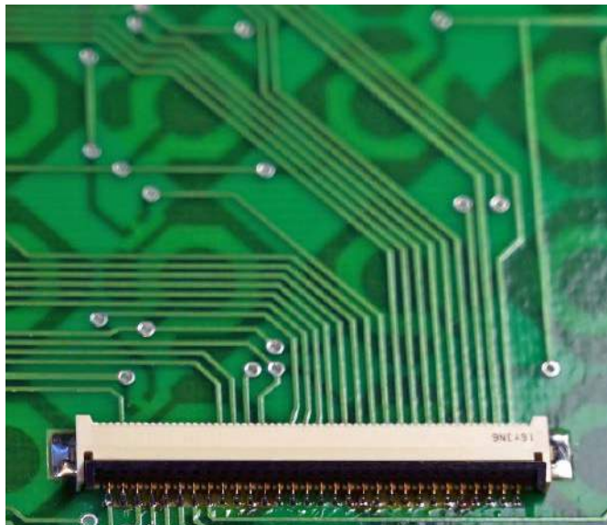
Fotografia 5. Klawiatura z gniazdem służącym do połączenia zewnętrzną taśmą
