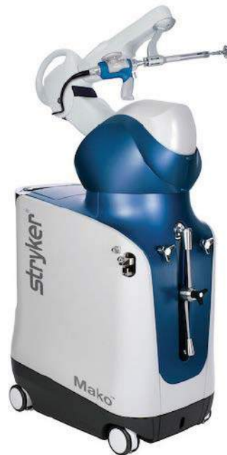
Fotografia 17. Robot Mako do wspomagania operacji endoprotezoplastyki całkowitej stawu biodrowego ( https://t.ly/3Zh4i )
