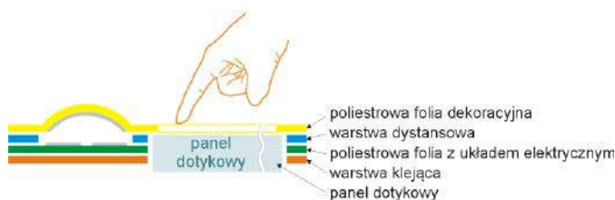
Rysunek 7. Przekrój klawiatury z panelem dotykowym
