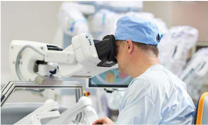
Fotografia 10. Smukła konstrukcja konsoli operatorskiej robota awatera umożliwia bezproblemową komunikację głosową chirurga z personelem, znajdującym się w sali operacyjnej ( https://t.ly/5Nmm6 )
