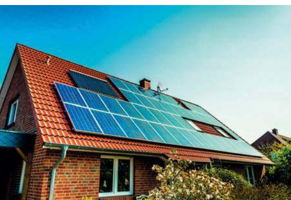
📌 Kolektory słoneczne do podgrzewania ciepłej wody użytkowej na dachu typowego domu montuje się dwa lub trzy – tu są u góry po lewej. Panele fotowoltaiczne potrzebują więcej. DE DIETRICH
