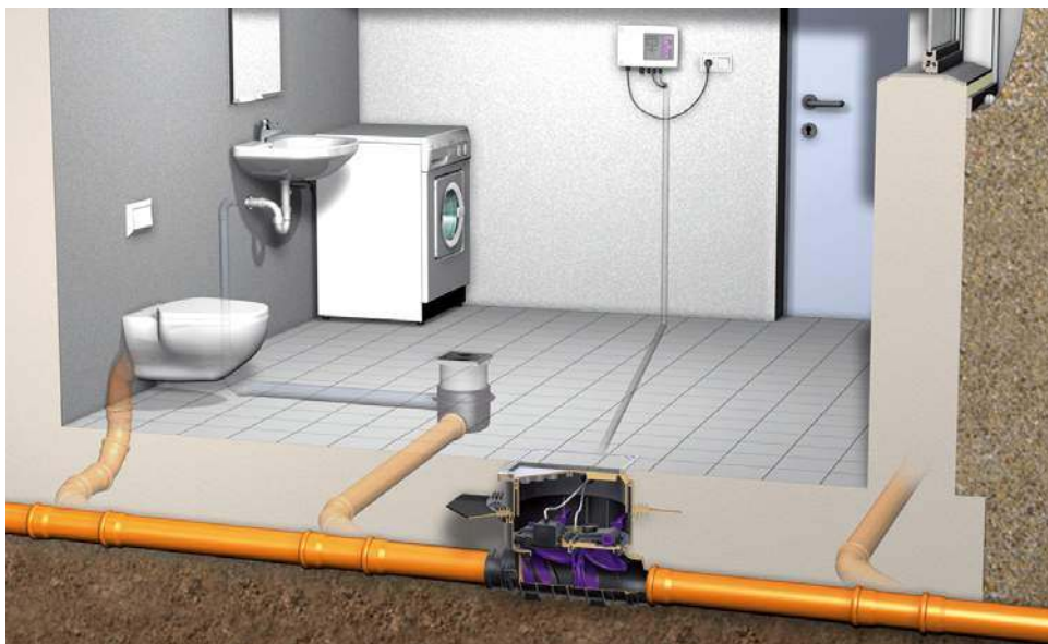
🔧 W piwnicy warto zamontować zawór przeciwwzalewowy, który zapobiega wdzieraniu się wody z kanalizacji do budynku. KESSEL
