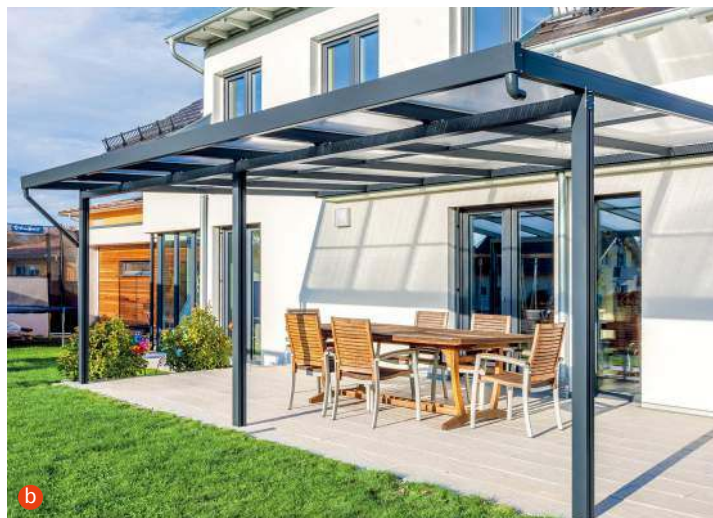
(a) Zadaszenie z poliwęglanu na konstrukcji aluminiowej z dwoma (a) i trzema (b) pionowymi podporami (słupami). GUTTA
