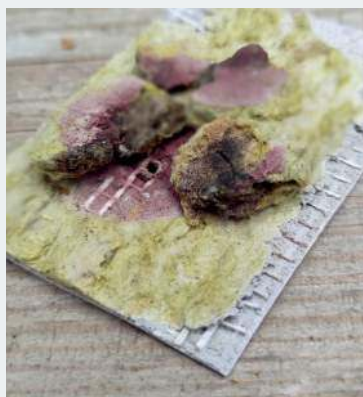
Wykrojony tynk i wełna mineralna ze źle zmieloną grudką żelaza.
