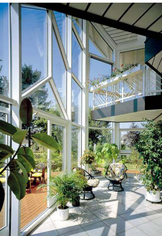
Najwyższe i najszerze przeszklenia wykonuje się z profili aluminiowych. VEKA
